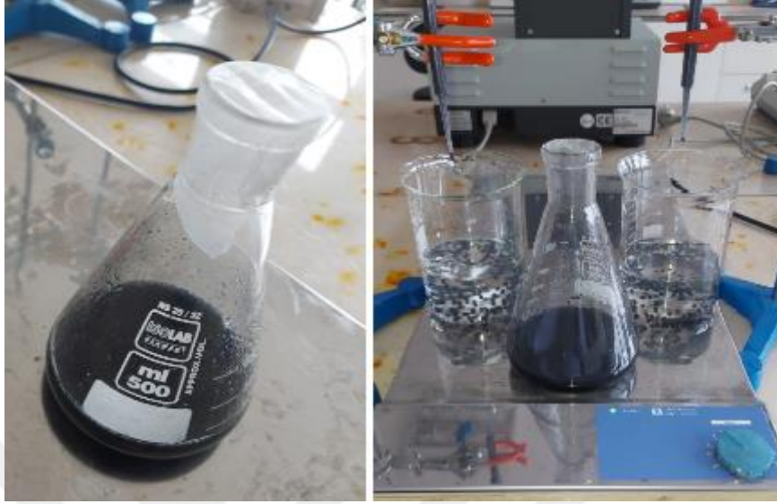
Resim 3.5. Biyoçar ve kitosan, mikrokapsül boncuklaştırma işlemi BÇ.
