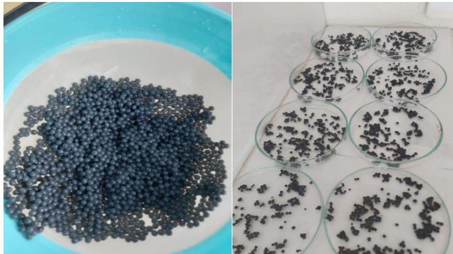
Resim 3.6. Çapraz bağlamadan önce yıkanmış mikrokapsüller BÇ.
