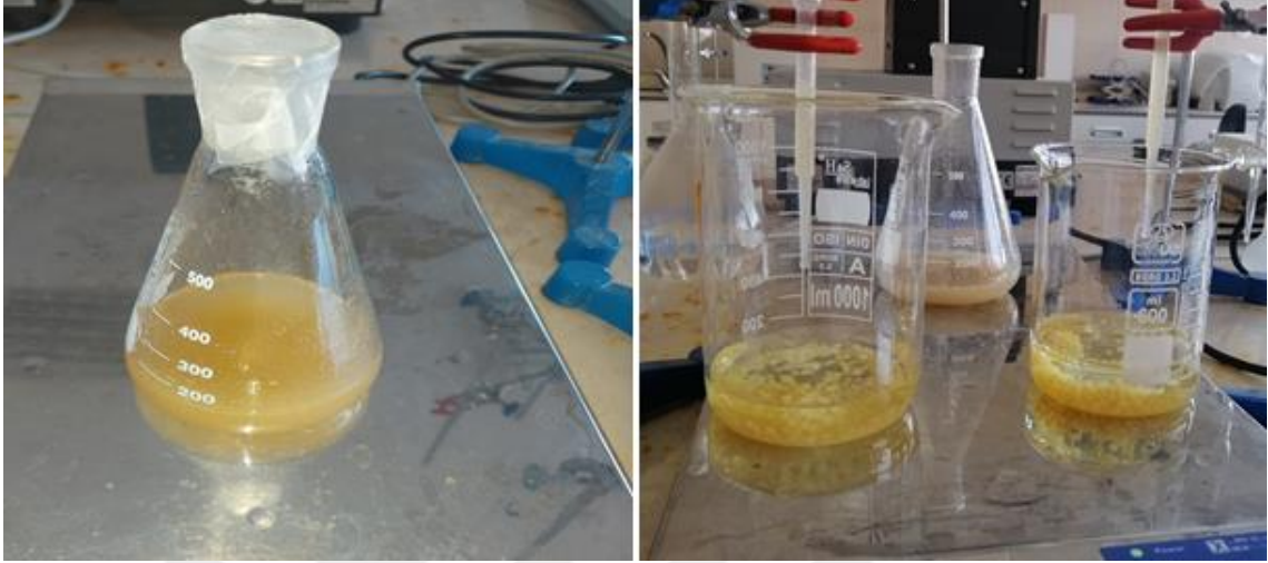
Resim 3.1. (a) Kitosan ve asetik asit çözeltisi, (b) Mikrokapsül boncuklaştırma işlemi
