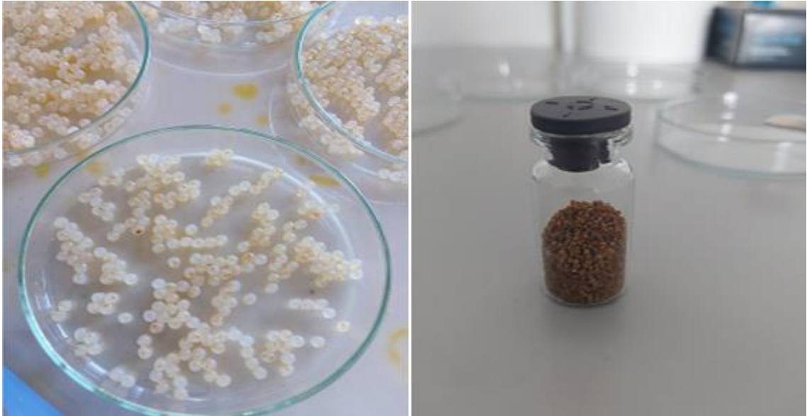
Resim 3.2. (a) Çapraz bağlamadan önce yıkanmış mikrokapsüller, (b) modifiye edilmiş zeytin çekirdeği
