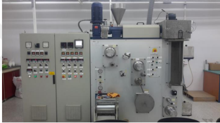
Şekil 2.5 PHBV polimerinden lif üretiminde kullanılan eriyikten lif çekim cihazı; Plantex Lab Line (Kişisel arşiv, 2019)
