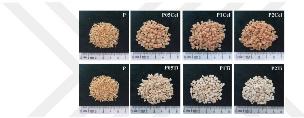
Şekil 3.38 Çift vidalı ekstruderde fonksiyonel katkı maddeleri selüloz ve \text{TiO}_2 ile hazırlanan katkılı polimerler (Kişisel arşiv, 2018)
