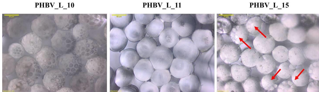
Şekil 3.24 Deniz/ada düze paketi ile hazırlanan bikomponent liflerin optik mikroskop görüntüleri (büyütme 40X)
