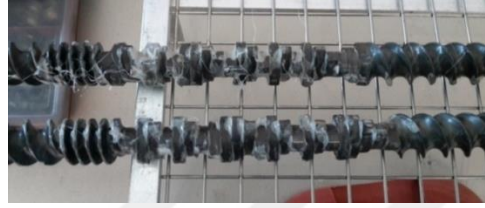
Şekil 3.71 Ekstruder vidası etrafına yapışan P3HB katkılı polimer kalıntıları (Kişisel arşiv, 2018)
