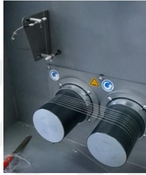
Şekil 3.20 Kabuk/öz düzesi ile bikomponent lif üretiminde alım silindiri üzerine sarılı lifler (PHBV_L_9) (Kişisel arşiv, 2019)
