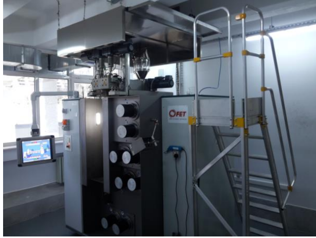
Şekil 2.6 PHBV polimerinden lif üretiminde kullanılan bikomponent lif çekim cihazı; FET Fibre Extrusion Technology (Kişisel arşiv, 2019)
