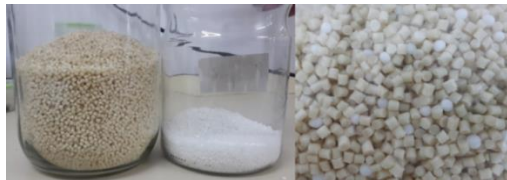
Şekil 2.7 Lif üretimi öncesinde polimer ve katkı maddesinin mekanik olarak karıştırılması (Kişisel arşiv, 2019)
