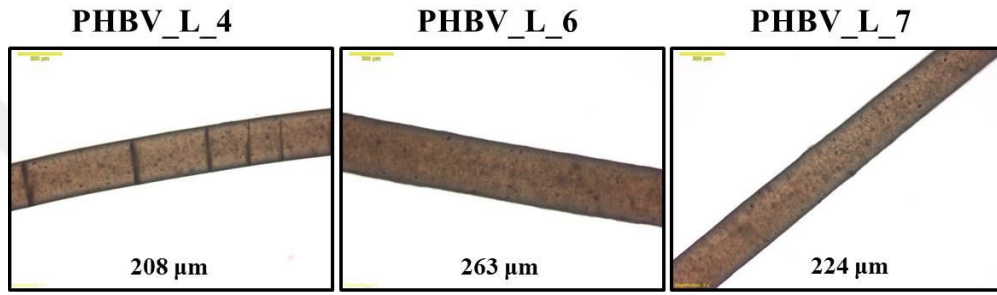
Şekil 3.13 Farklı oranlarda işlem iyileştirici ajan katkılı PHBV liflerinin optik mikroskop görüntüleri (X10 büyütme, ölçek 200 \mu m)
