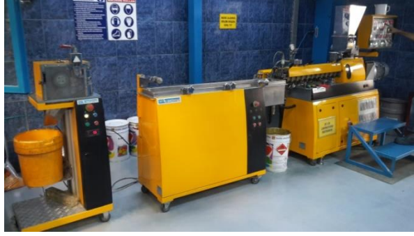
Şekil 2.1 PHBV katkılı polimerlerin hazırlanmasında kullanılan çift vidalı ekstruder (Kişisel arşiv, 2017)
