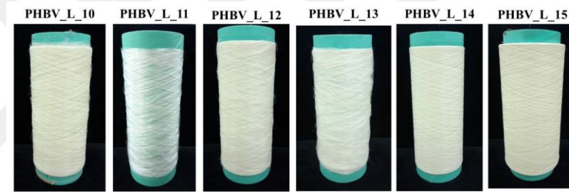
Şekil 3.21 Deniz/ada düzesi ile üretilen PHBV/PLA bikomponent bobinlerinin dijital görüntüleri (Kişisel arşiv, 2020)
