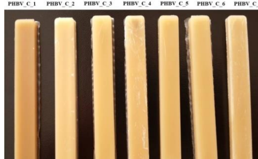
Şekil 3.57 Çift vidalı mikro karıştırıcıda plastikleştiriciler ile hazırlanan katkılı polimerler (numune ebatı 80x10x4 mm) (Kişisel arşiv, 2019)
