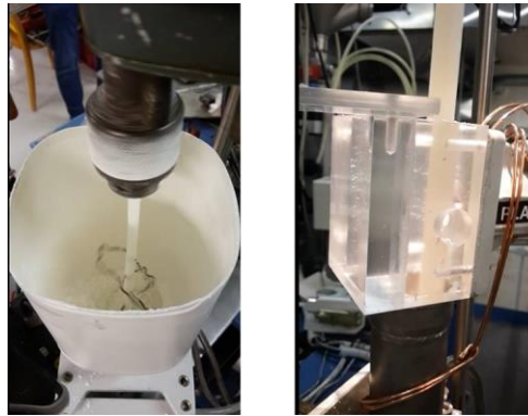
Şekil 3.70 Ekstrüzyon işleminde polimer besleme hızını arttırmak için uygulanan modifikasyonlar (Kişisel arşiv, 2018)
