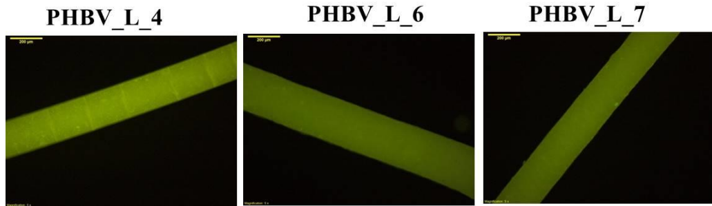
Şekil 3.14 Farklı oranlarda işlem iyileştirici ajan katkılı PHBV liflerinin floresans mikroskop görüntüleri; a) PHBV_L_4 b) PHBV_L_6 c) PHBV_L_7 (X10 büyütme, ölçek 200 \mu m)
