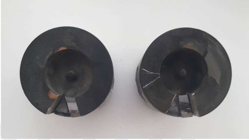
Şekil 6.2. Ni-Al ve Ni-Cr ara bağlayıcılı Al_2O_3 kaplamalı piston görüntüsü.
