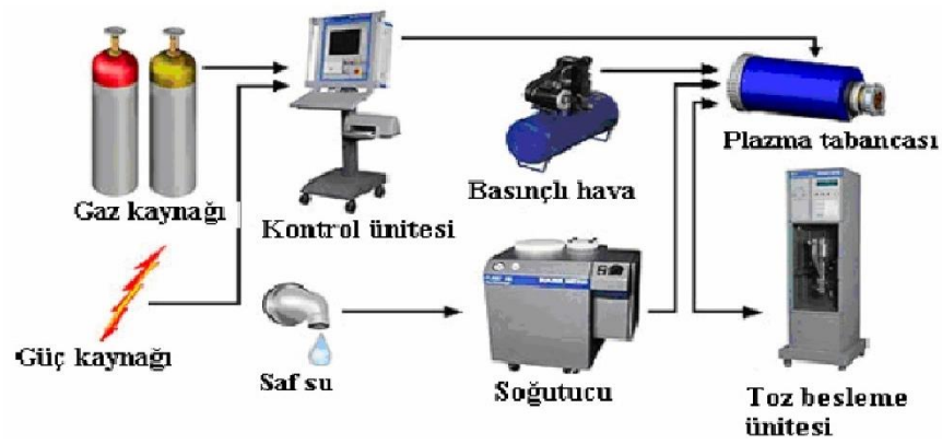
Şekil 4.1. Plazma spre yöntemi ekipmanları (Gürbüz, 2013).
