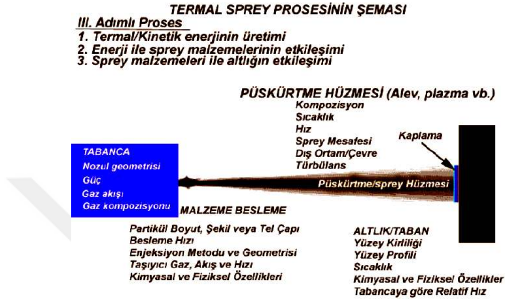
Şekil 4.3. Plazma spray yönteminde etkili olan temel parametreler (Üstel vd., 2006).
