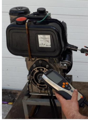
Şekil 6.19. Yüzey sıcaklık ölçüm cihazı ile sıcaklık ölçümü.
