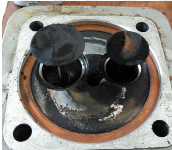
Şekil 6.16. Ni-Al ara bağlayıcılı Al_2O_3 kaplamalı subapların biyodizel yakıt çalışmış görüntüsü.
