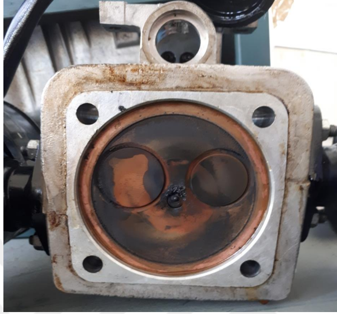
Şekil 6.17. Ni-Cr ara bağlayıcılı Al_2O_3 kaplamalı subapların biyodizel yakıt ile çalışmış görüntüsü.
