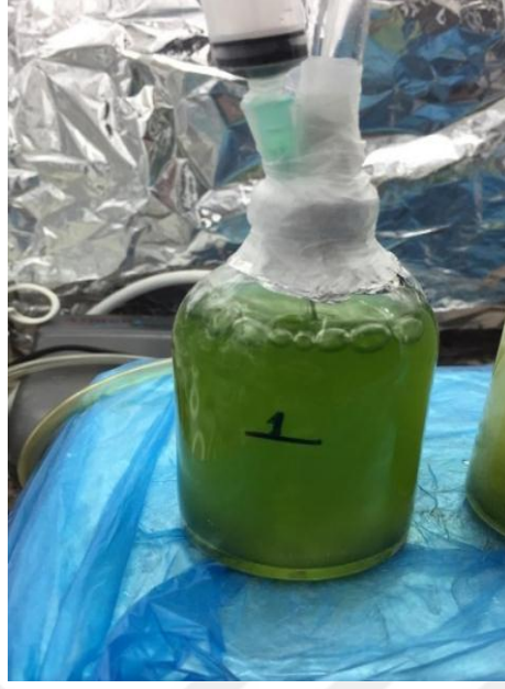
Şekil 3.3. Agarlı besiyerinden alınan saf türlerin çoğaltılması için kullanılan fotobiyoreaktörün görünümü
