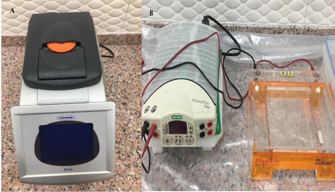
Şekil 3.4. A: PCR işleminde kullanılan cihaz, B: agaroz jel elektroforezi
