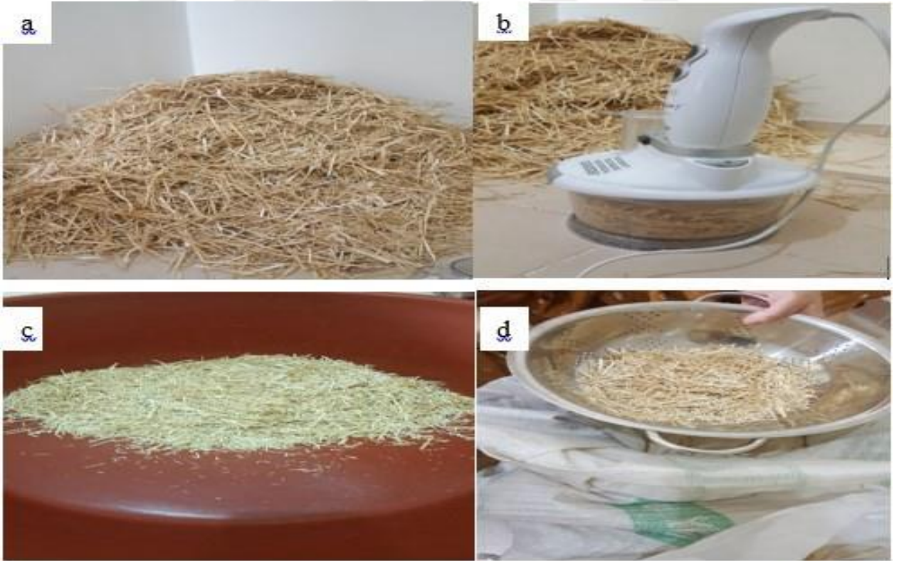
Şekil 2.2. a. Malatya Doğanşehir ilçesinden temin edilen buğday sapları, b. Buğday saplarının saman haline getirme çalışması, c. Buğday saplarının saman haline getirilmesi, d. Buğday sapını saman haline geldikten sonra tozundan arındırmak için yapılan eleme işlemi
