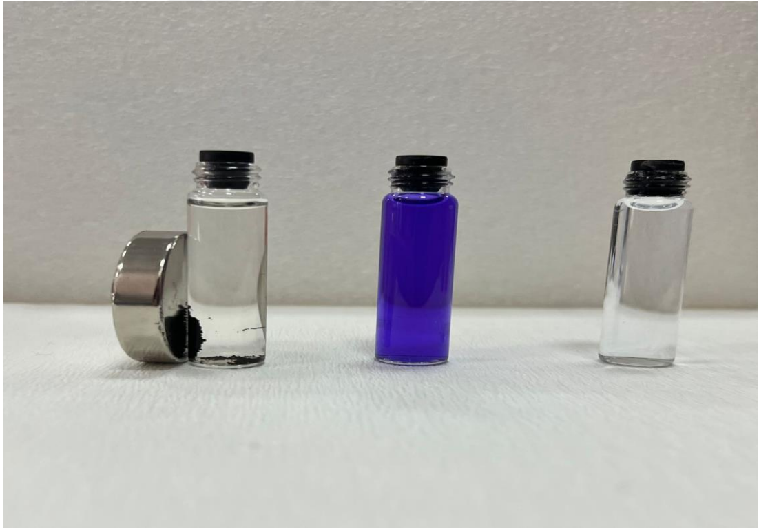
Şekil 4.8 Z-MNP, adsorpsiyon öncesi ve adsorpsiyon sonrası KV görüntüleri
