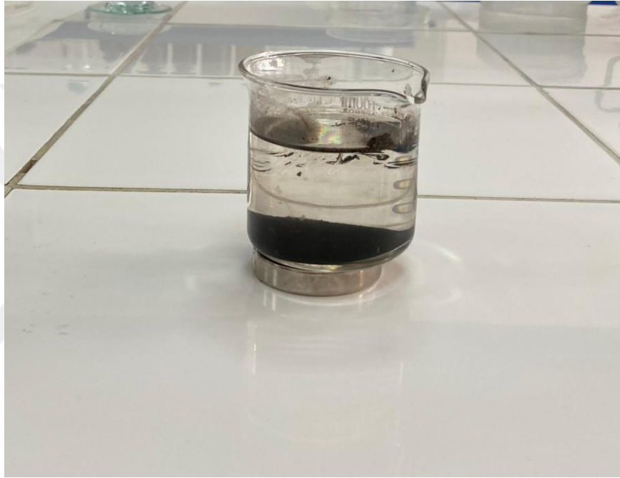
Şekil 4.1 Sentezlenen Z-MNP partiküllerin mıknatısla çöktürülmüş görüntüsü
