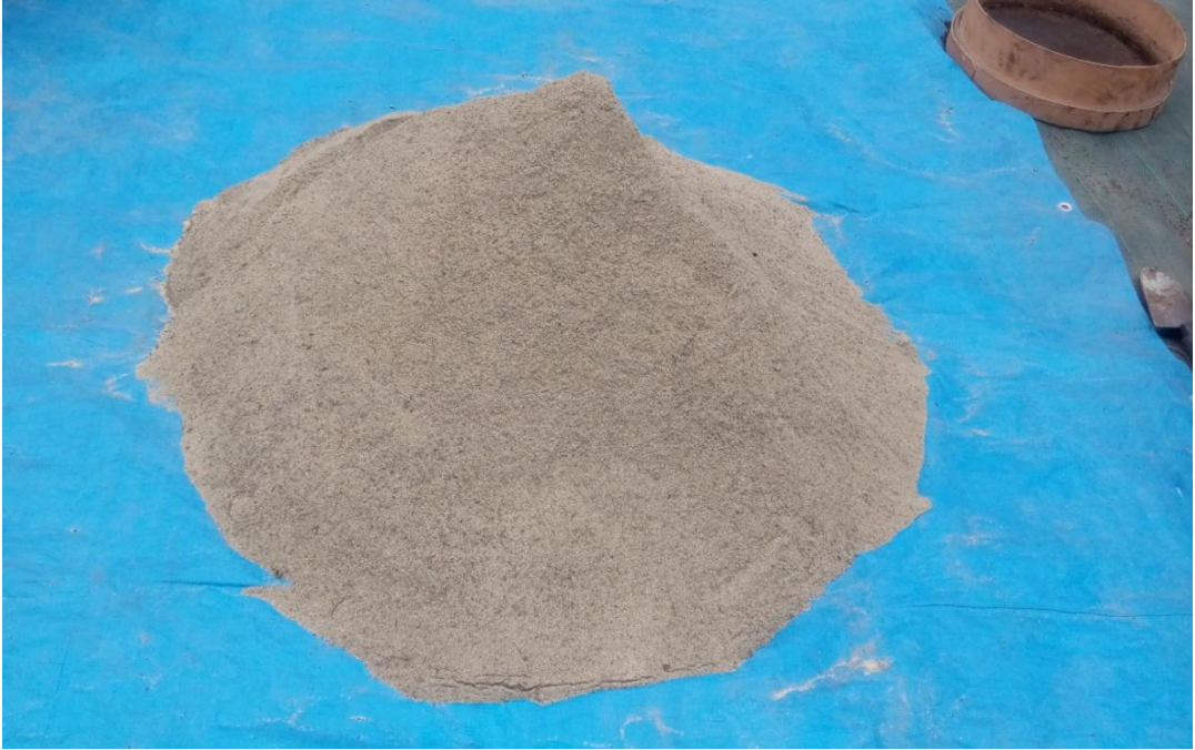
Şekil 3.26: Karışık toprak örnekleri (kirli toprak (Teknosol) + %5 sert ağaç biyokömürü + %5 kompost).
