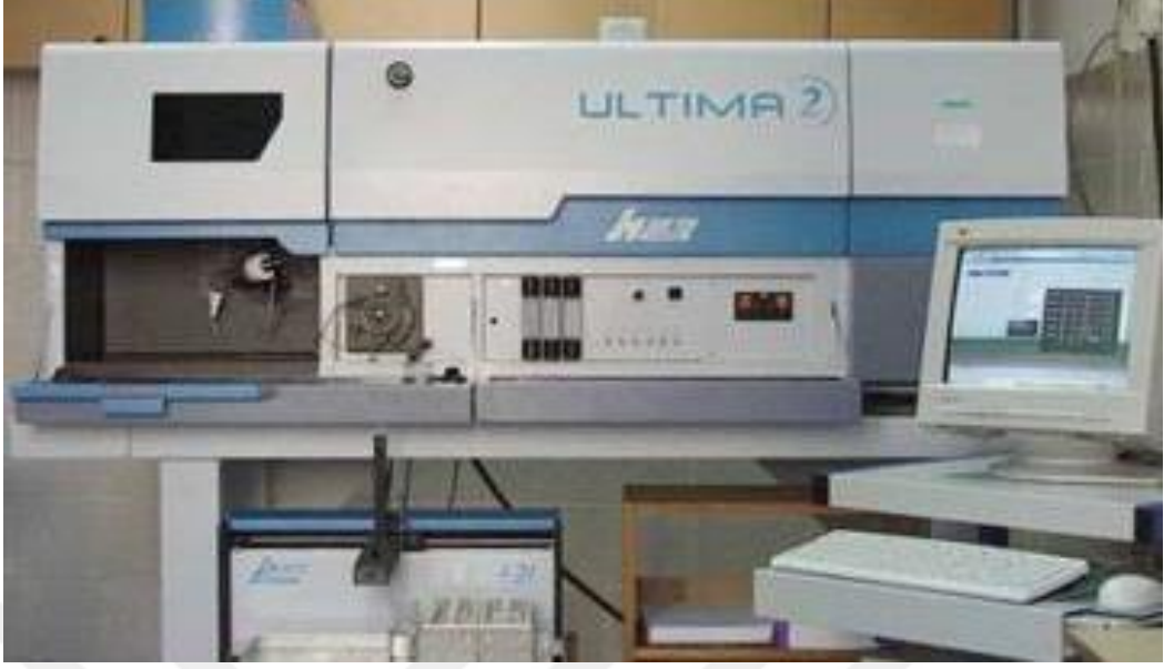
Şekil 3.18: ICP-AES (Plazma Atomik Emisyon Spektroskopi- ULTIMA 2, HORIBA, Labcompare, San Francisco, California).
