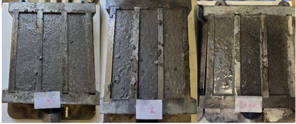
Görsel 5.3. %0,5; 1 ve 2 oranlarında BK eklenmiş harç örnekleri
