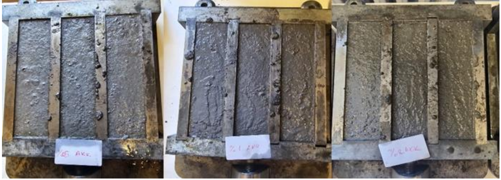
Görsel 5.5. %0,5; 1 ve 2 oranlarında AKK eklenmiş harç örnekleri
