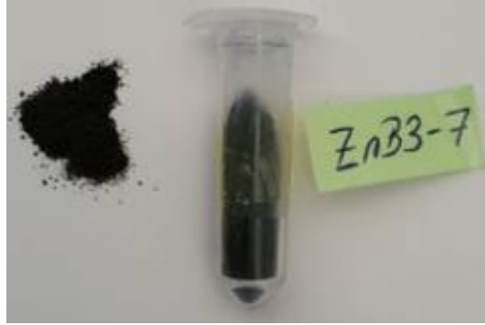
Şekil 4. 26: \text{ZnNi}_2\text{S}_4 sentezi için sülfür eklendikten sonraki süre optimizasyonu fotoğrafları
