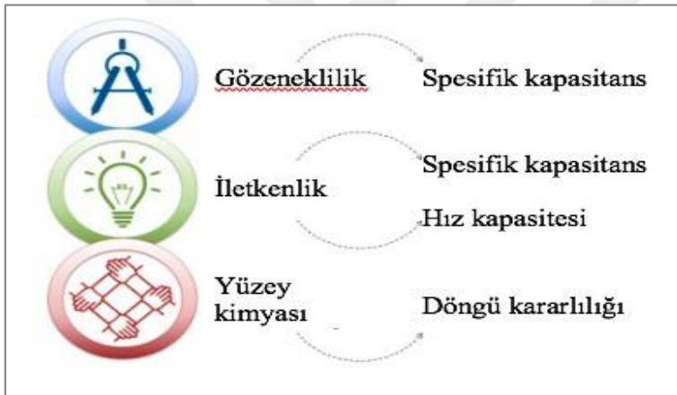
Şekil 2.7. Elektrot malzemesinin özellikleri ve kapasitörün performansı arasındaki etkileşim (Conder vd., 2019)
