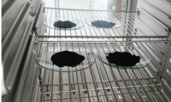
Şekil 5.8. Etüvde Kurutma İşlemi
