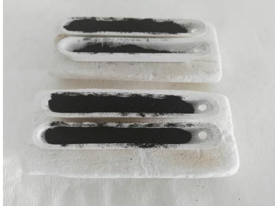
Şekil 5.12. Kalsinasyon Fırını Çıkışı Küvetlerde Aktif Karbon
