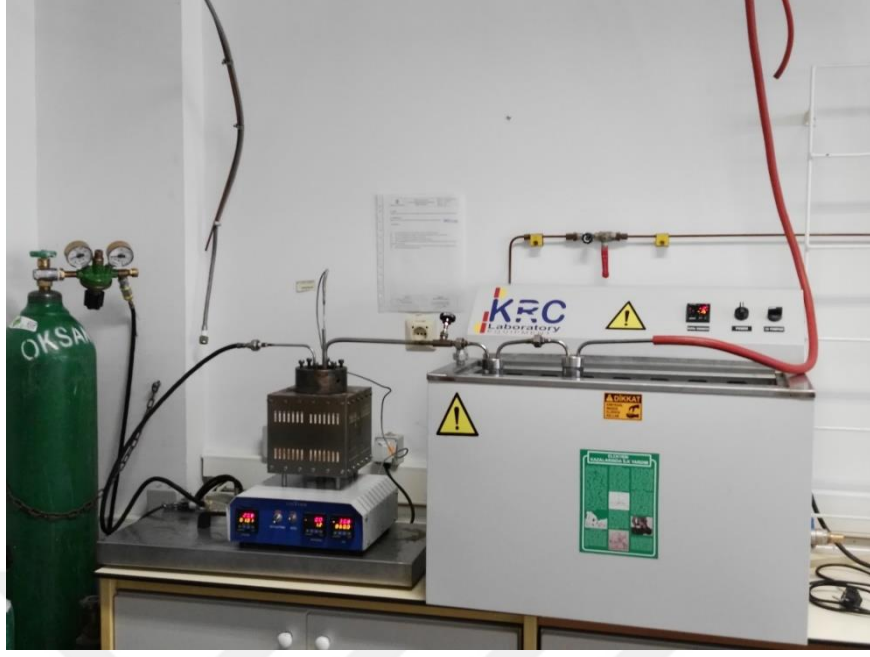
Şekil 5.6. Sabit Yataklı Reaktör ve Gaz Soğutma Ünitesi
