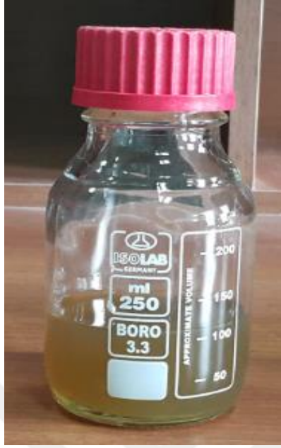
Şekil 2.1 Pakmaya Maya Endüstrisi Düzce tesislerinin anaerobik arıtma tesisi çamur çürütücü tankından alınan arıtma çamuru (a) ve çamurunun karakterizasyonu (b)
