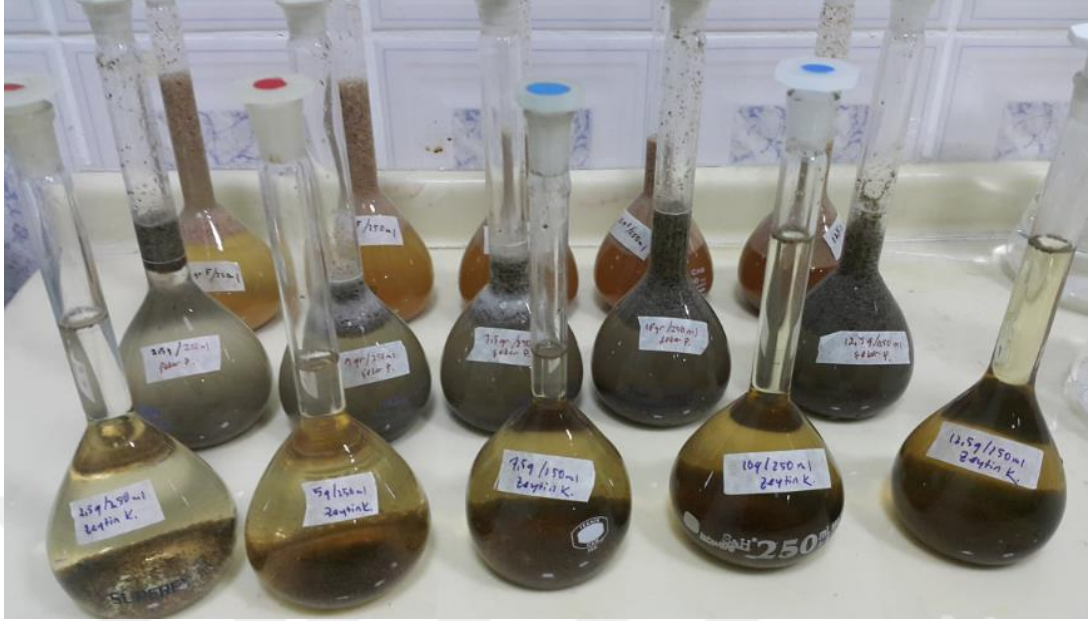
Resim 2.4 Farklı substrat konsantrasyonlarında hazırlanmış ve ön işlemden geçirilmiş biyokütle çözeltileri (önden arkaya doğru: zeytin küspesi, şeker pancarı küspesi, fıstık küspesi) (soldan sağa doğru substrat derişimleri: 10 g/L, 20 g/L, 30 g/L, 40 g/L, 50 g/L)
