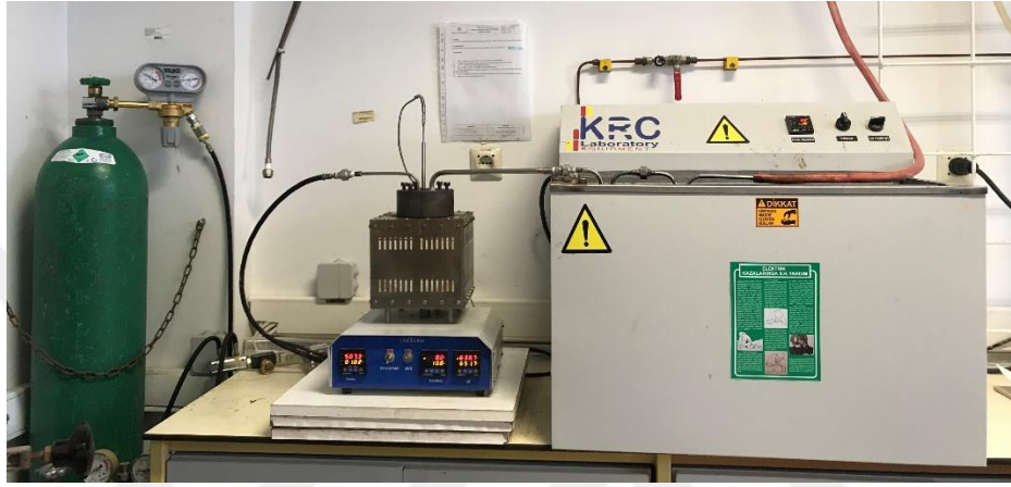
Şekil 4.3. Karbonizasyon deney düzeneği
