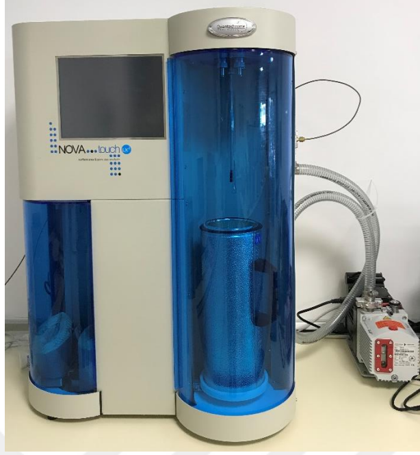
Şekil 4.8. Deneyisel çalışmalarda kullanılan NOVAtouch Quantachrome cihazı
