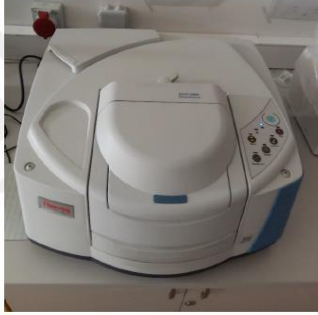
Şekil 4.10. FTIR analizleri için kullanılan Thermo Scientific Nicolet iS10 FTIR Spektrometre Cihazı
