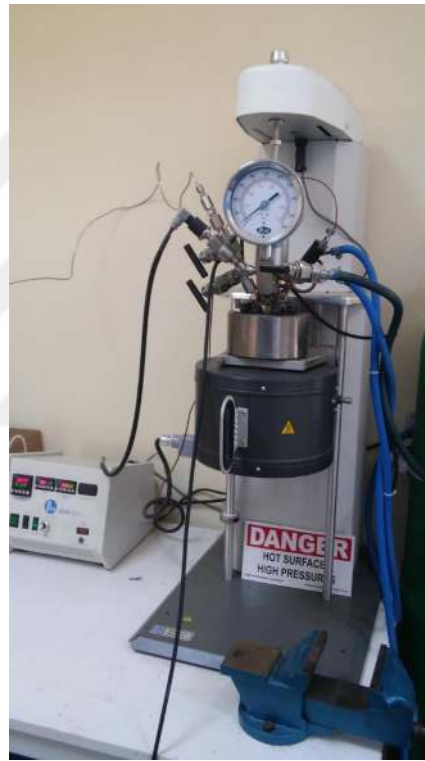
Şekil 5.1. Hidrotermal ön işlem için kullanılan reaktör düzeneği.
