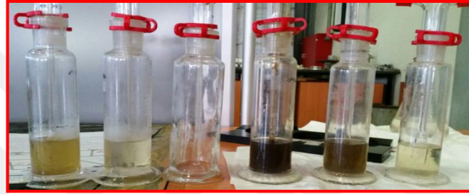
Şekil 3.2. Katran toplama şişeleri
