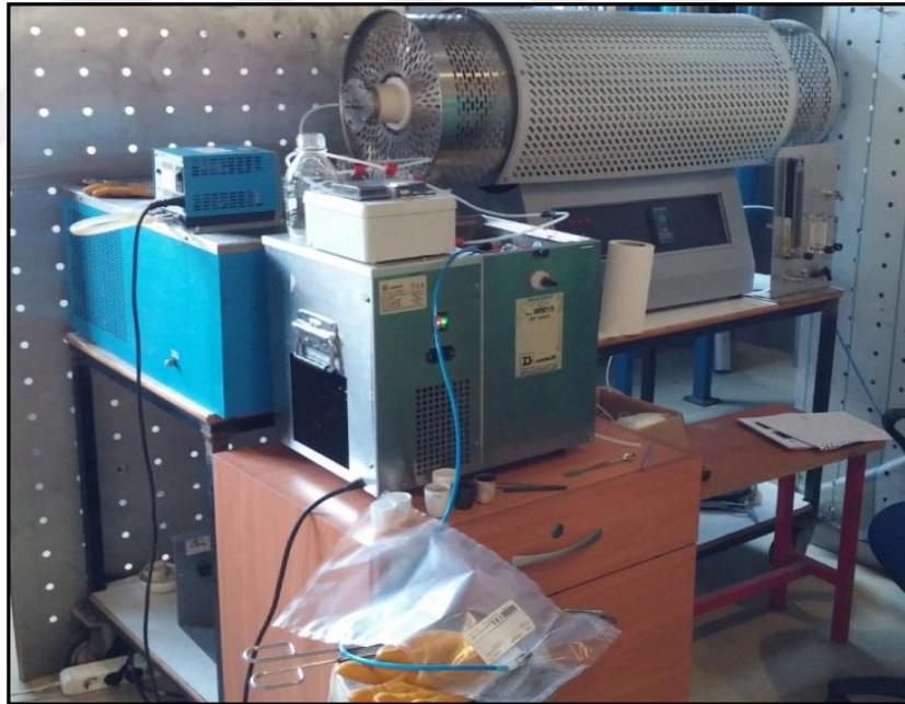
Şekil 3.1. Laboratuvar ölçekli yatay tüp fırın
