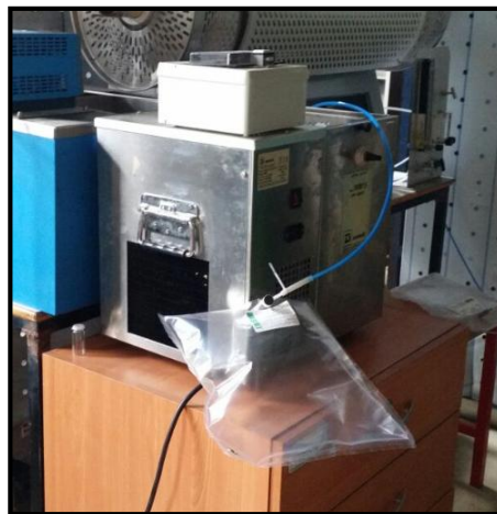
Şekil 3.3. Gaz numunesi toplama torbası (tedlar bag)
