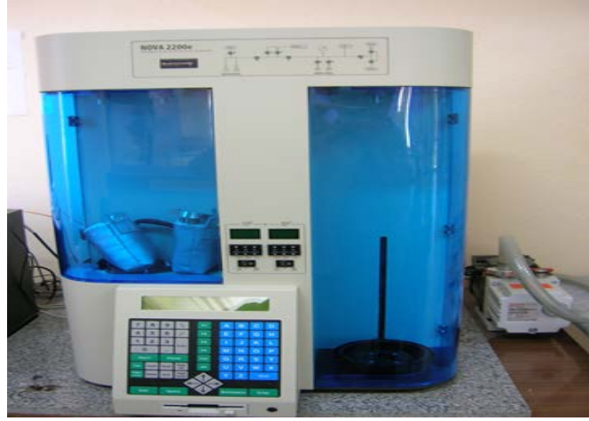
Şekil 5.5. BET cihazının şematik görünüşü [79]
