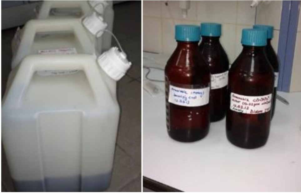
Şekil 3.1 : Atıksu numunelerinin polietilen kap ve amber cam şişelerde saklanması.
