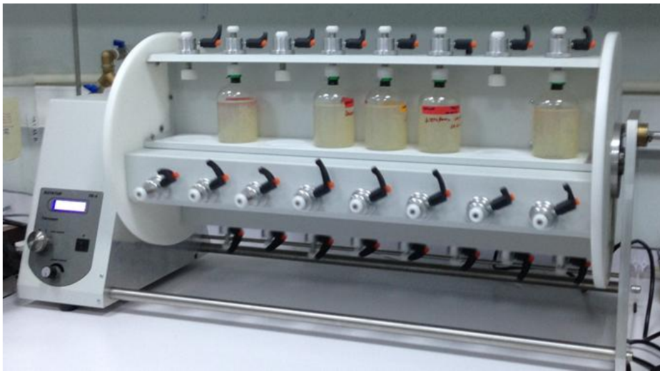
Şekil 3.4 : Kesikli deney süresince reaktörlerin karışımının sağlandığı döner karıştırıcı.
