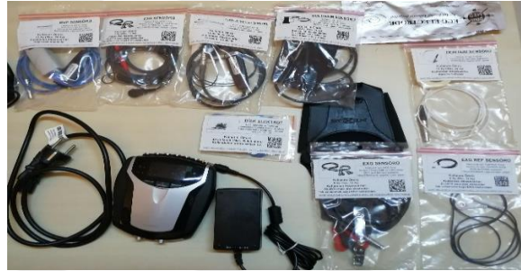
Resim 3.1. Nexus 10 Mk II neurofeedback / biofeedback ve fizyolojik görüntüleme, değerlendirme ve geri besleme sistemi
