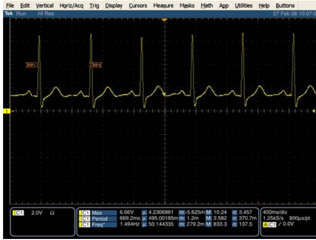
Şekil 3.5. Gerçekleştirilen sistemle ölçülmüş EKG işaretleri
