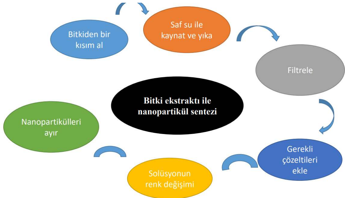
Şekil 1.4 Bitki özü kullanılarak nanopartiküllerin yeşil sentezi için çevre dostu ve ucuz yol(Jadoun et al., 2021)
