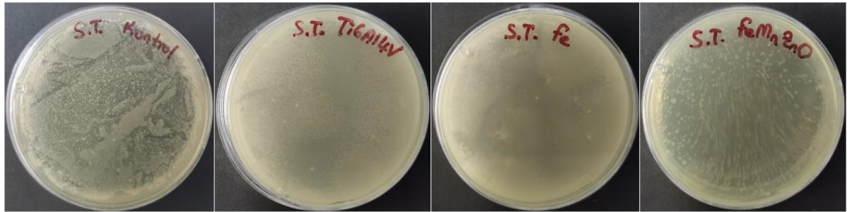
Şekil 3.16 Metal ve metal alaşım biyomalzemelerin plak sayma metodu deneyi Salmonella typhirium .
