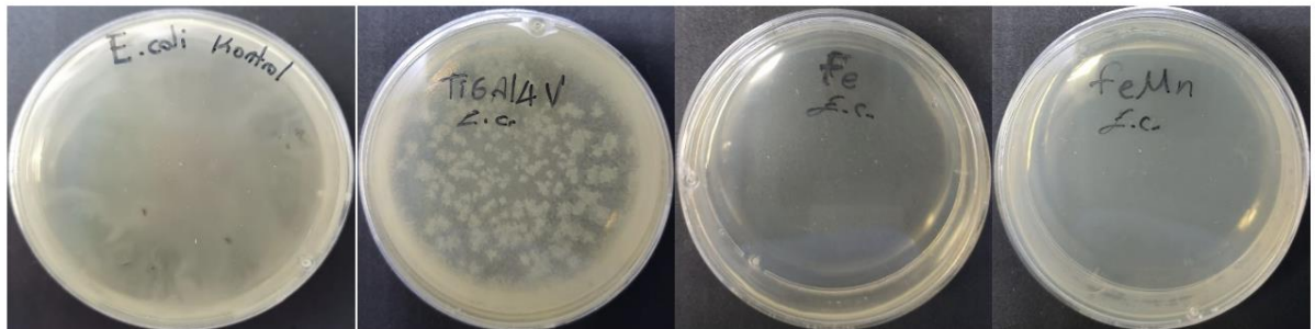
Şekil 3.17 Metal ve metal alaşım biyomalzemelerin plak sayma metodu deneyi Escherichia coli .
