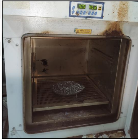
Şekil 13. Ti talaşlarının vakum atmosferli fırın içinde kurutulması
