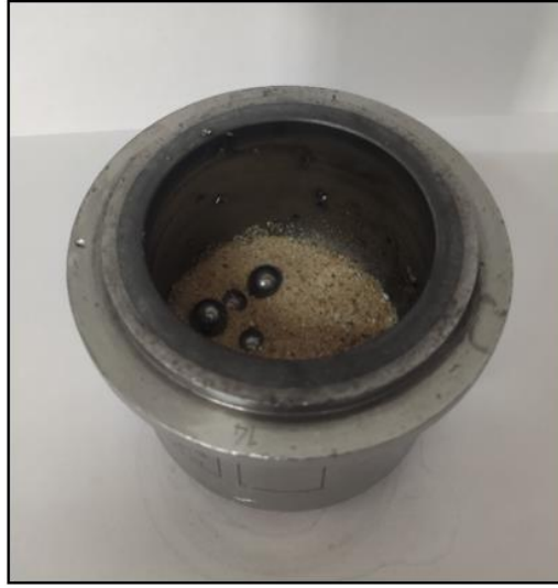
Şekil 31. Hazne ve bilyelerin silisyum kumu ile temizlenmesi
