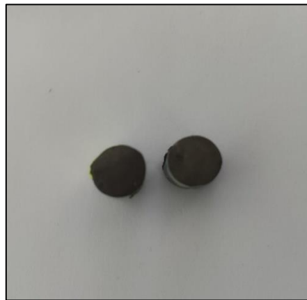
Şekil 38. Reçine ile kalıplanmış Ti tozları
