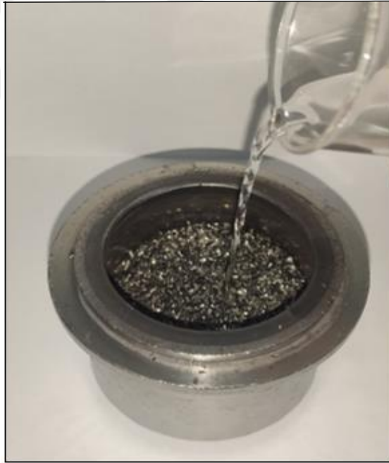
Şekil 19. Kırılmış Ti talaş ve etanolün öğütücü hazneye yerleştirilmesi
