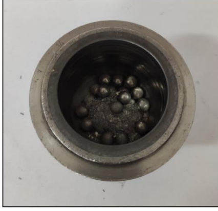
Şekil 28. Öğütme işlemi sonrası öğütücü hazne
