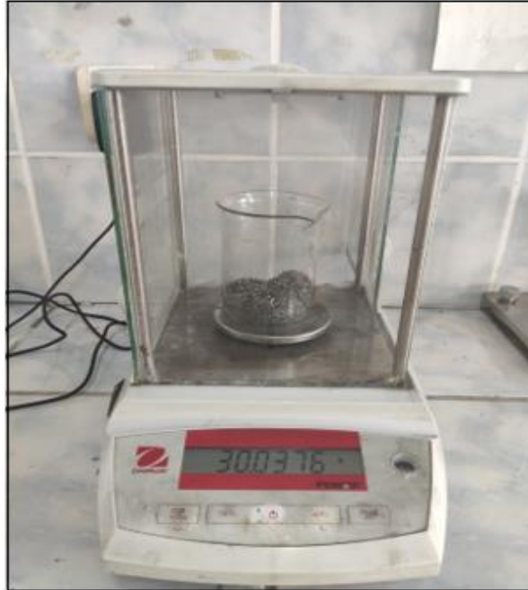
řekil 17. Islak tlecek Ti talařının hassas terazide tartılması
