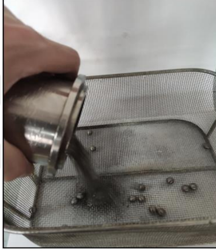
Şekil 29. Öğütme işlemi biten Ti talaşın hazneden alınması
