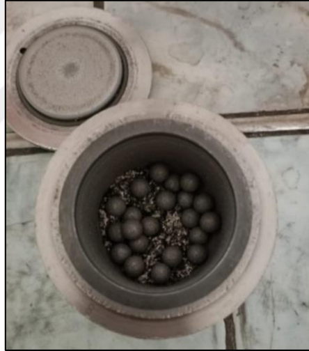
Şekil 27. Toz-bilye oranı hesaplanan ıslak öğütülmüş Ti talaşlarının hazne içine yerleştirilmesi
