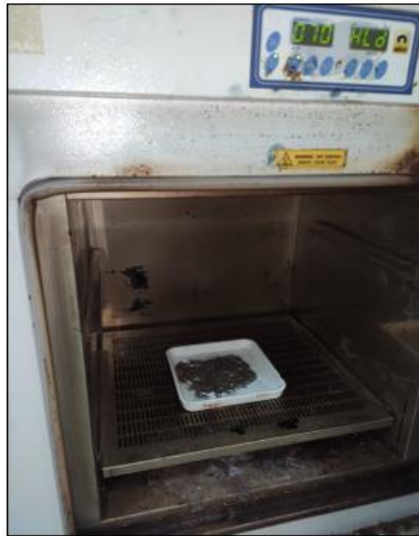
Şekil 23. Ti talaşlarının etüv fırında kurutulma işlemi
