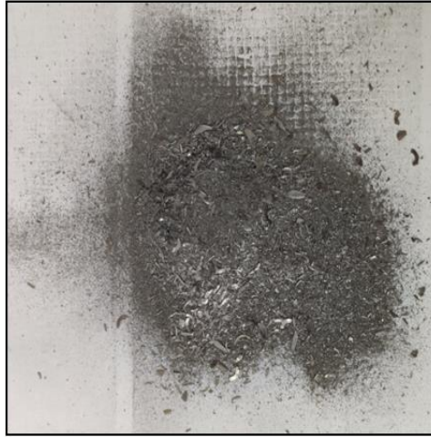
Şekil 30. Kuru öğütme sonrası elde edilen Ti parçacıkları
