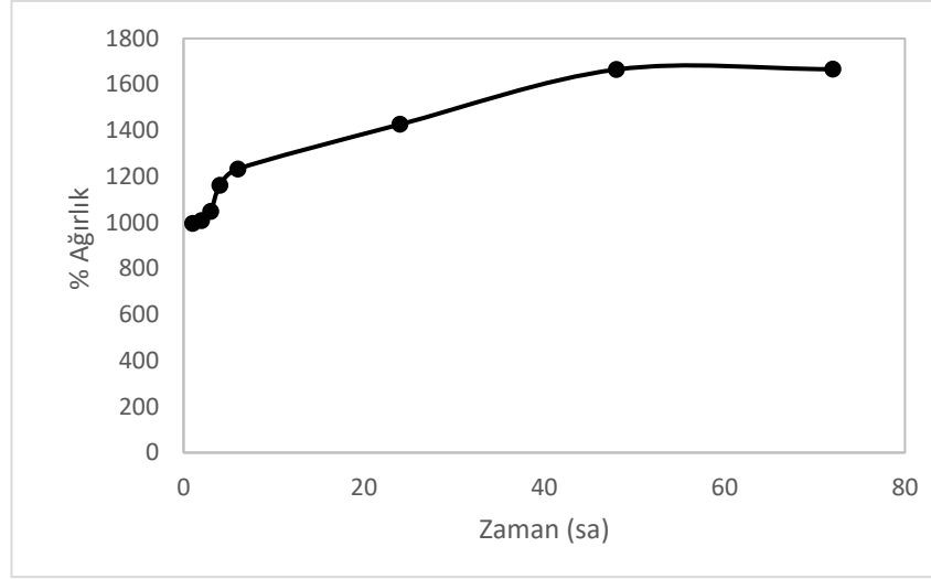
Şekil 7.43. Çapraz bağlama işlemi uygulanan filmin şişme testi sonucu ağırlık artışı (g)
