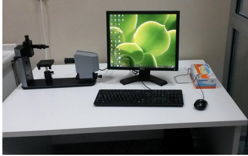
Şekil 5.9 Temas açısı ölçüm cihazı
