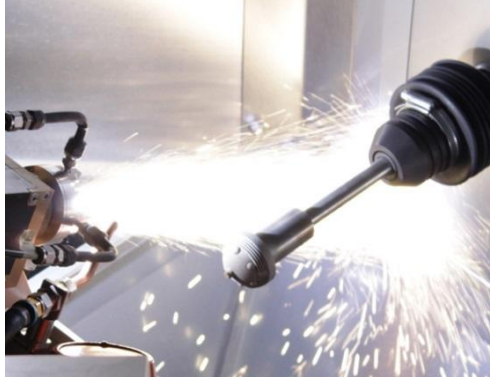
Şekil 3.5 Plazma püskürtme yöntemi ile HA kaplanan bir implant
