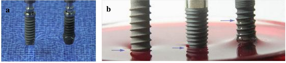
Şekil 4.5 Farklı yüzey özelliklerine sahip titanyum implantların su ve kan ile olan etkileşimine dair örnekler (a) Thommen Medical (b) Lasak LTD.
