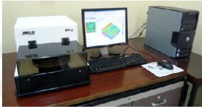
Şekil 5.8 Yüzey Profilometresi cihazı
