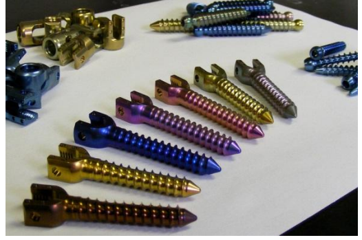
Şekil 3.4 Otomatik bir anotlama hattı (Nobelbiocare) ve anotlanmış titanyum vidalardan örnekler.
