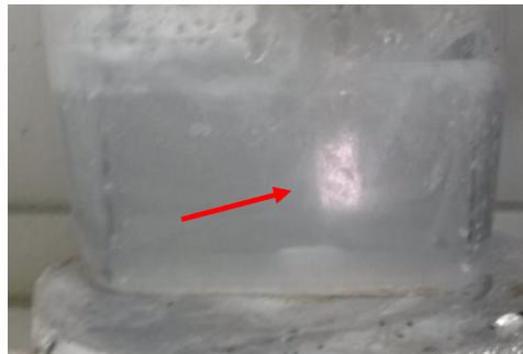
Şekil 6.18 Anotlama esnasında titanyum yüzeyinde spark oluşumu
