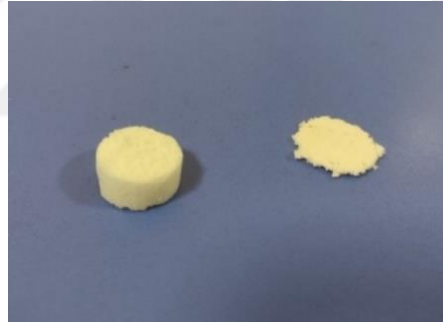
Görsel 9.1. Doku iskelesinin basma testi uygulanmadan önceki ve sonraki görüntüsü
