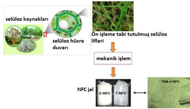
Şekil 4.2. Nanofibrillenmiş selüloz elde etmek için tanımlanan klasik işlem (Missoum, Belgacem, Bras, 2013)
