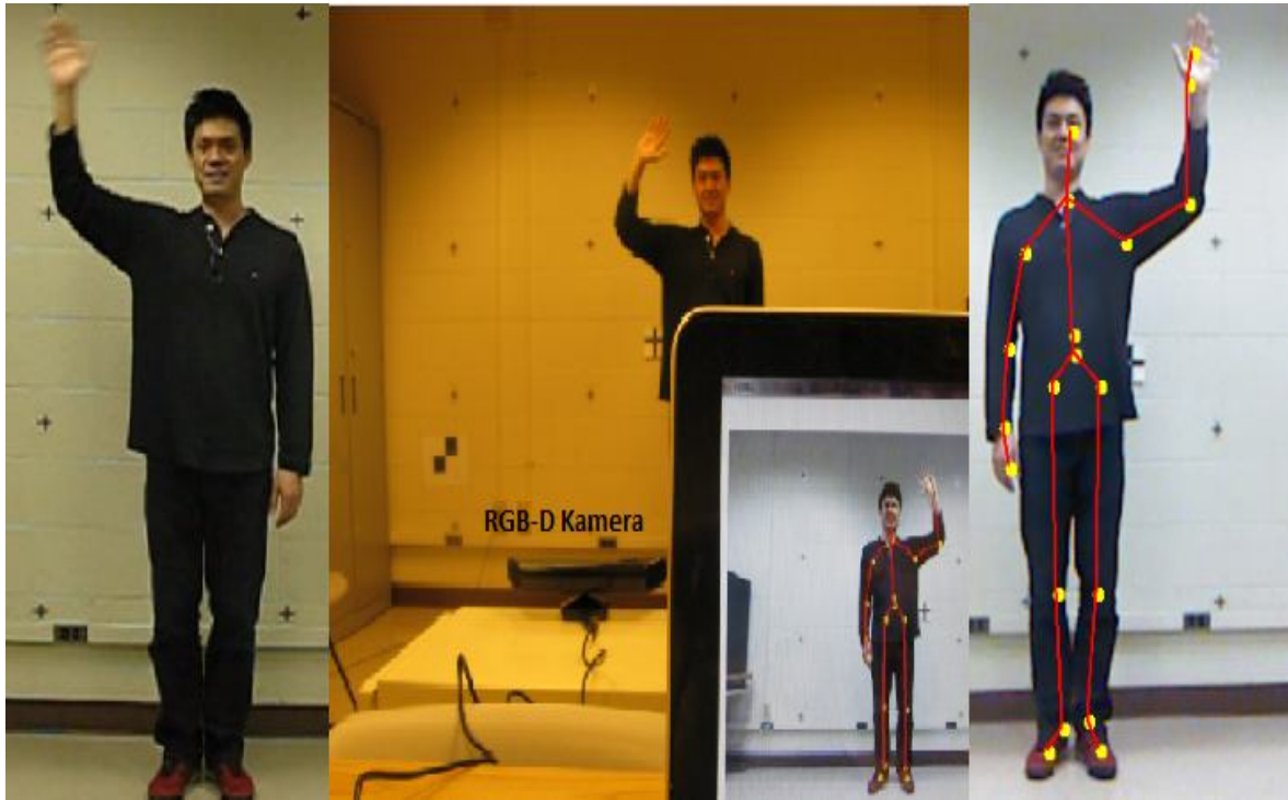
Şekil 2.3. RGB-D sensör üzerinden sanal iskelet testi ile hareketin algılanması
