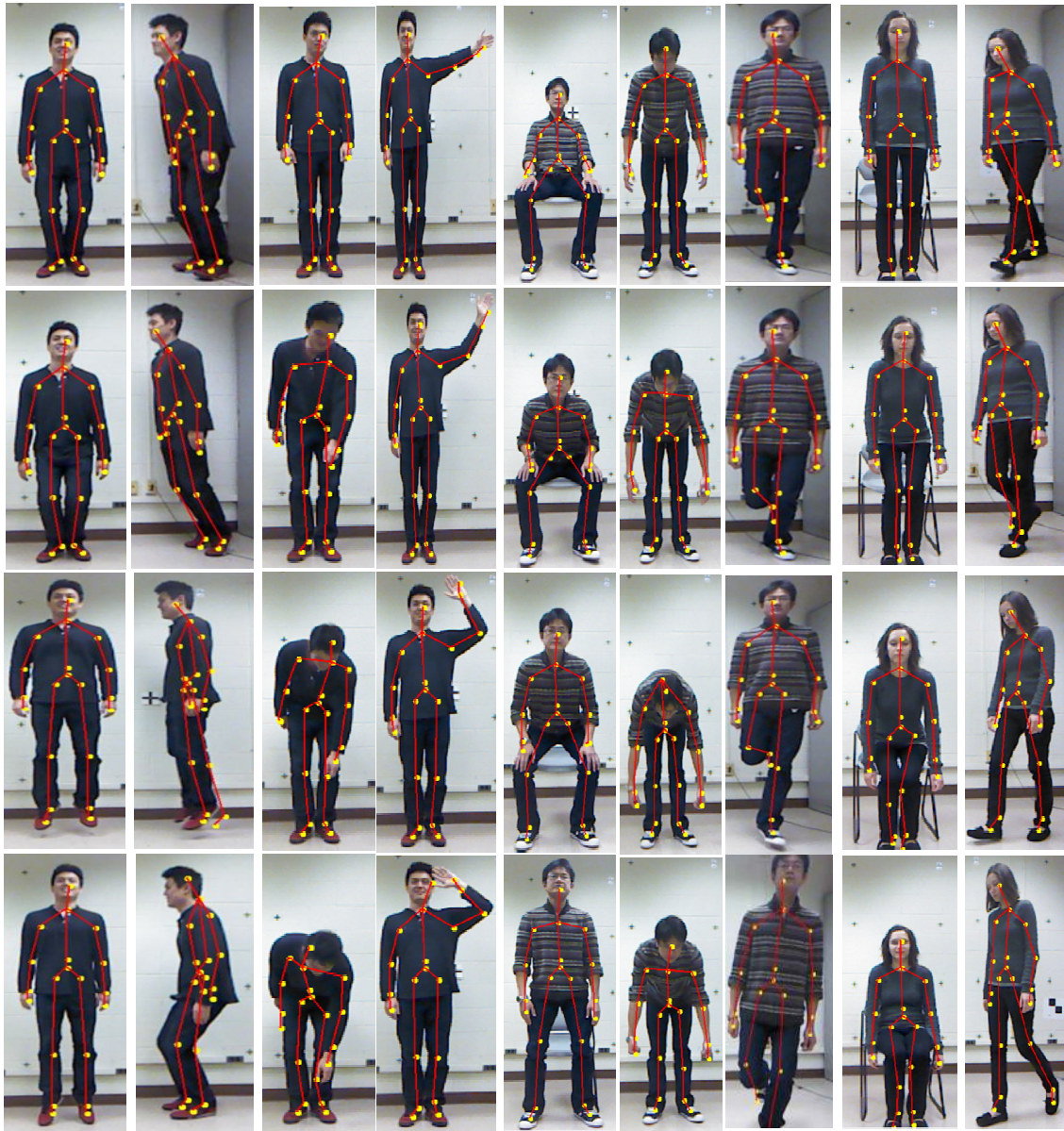
Şekil 4.2. Zıplama (A) , ileri zıplama (B), bir nesneyi alma (C), el sallama (D), kalkma (E), kaldırma (F), sekme (G),sekme (G), oturma (H), yürüme (I) hareketi ve eklemlerin iskelet modeli
