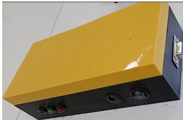
Resim 3.3 3B yazıcı ile üretilen elektronik sistemin kasası
