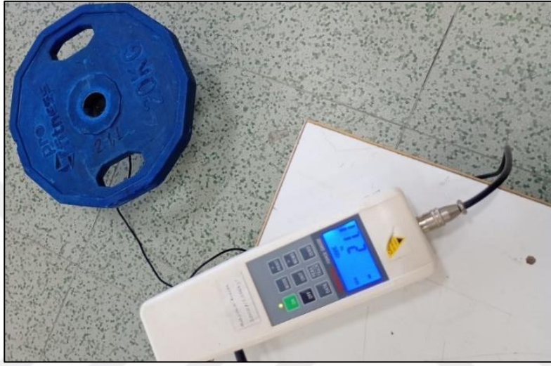
Resim 3.7 Referans yük ve referans ölçüm cihazı
