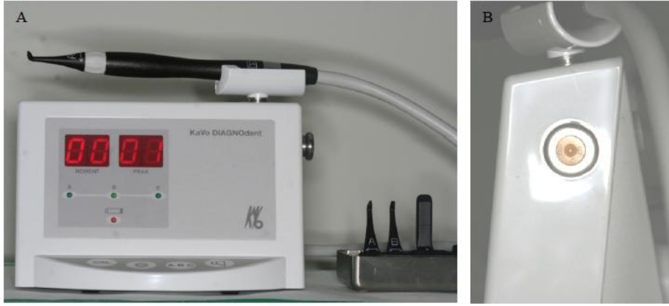
Şekil 2-11: (A) DIAGNOdent ve cihaza ilişkin probe A ve B (B) Kalibrasyon amacıyla cihazın yan tarafında bulunan seramik ölçek.
