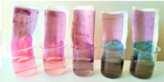
Görsel 64 : Alginat pat ile basılmış % 50 pamuk-%50 ipek kumaşların farklı pH değerlerindeki renk değişimleri
