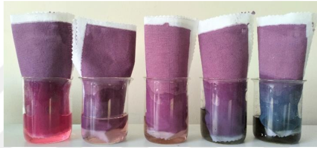
Görsel 51: Sentetik pat ile basılmış kumaşların farklı pH değerlerindeki renk değişimleri (Yıldız, 2019)
