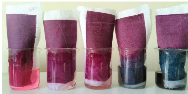
Görsel 57: Alginat pat ile basılmış pamuklu kumaşların farklı pH değerlerindeki renk değişimleri (Yıldız, 2019)
