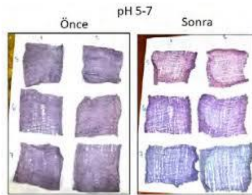
Görsel 47: Ahuduyla renklendirilmiş pamuklu sargı bezinin pH 5 - 7 özeltileri ile muamele edilmeden önceki ve sonraki görüntüleri (Pakolpakıl, Karaca, Becerir, 2019: 220)
