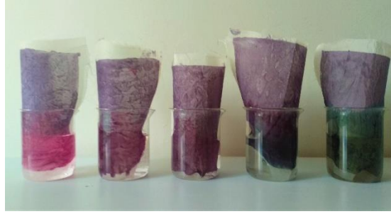
Görsel 65: Alginat pat ile basılmış % 100 ipek kumaşların farklı pH değerlerindeki renk değişimleri (Yıldız, 2019)
