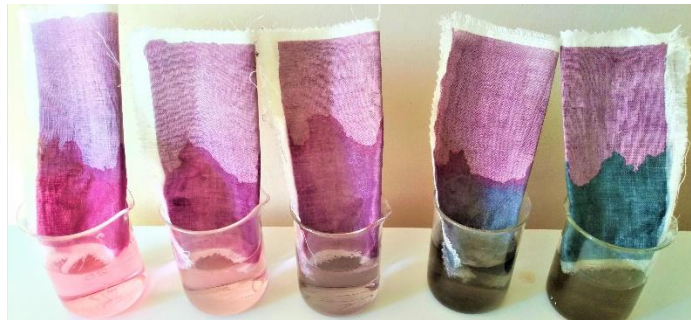
Görsel 63: Alginat pat ile basılmış keten kumaşların farklı pH değerlerindeki renk değişimleri (Yıldız, 2019)
