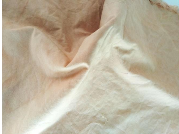
Görsel 74: pH 12 Değerindeki Bazik Ortamda Çektirme Yöntemi ile Boyama (Yıldız, 2019)
