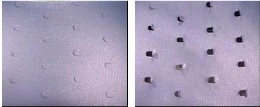
Görsel 42 : Çam kozalağından esinlenilerek yapılmış kompozit tekstil yüzeyi (Kapsali, 2009: 60)
