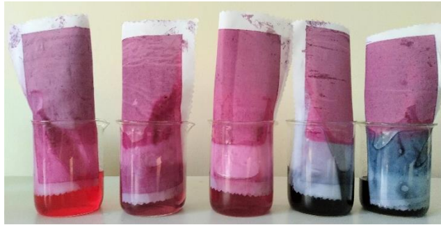
Görsel 61: Alginat pat ile basılmış poliester kumaşların farklı pH değerlerindeki renk değişimleri (Yıldız, 2019)
