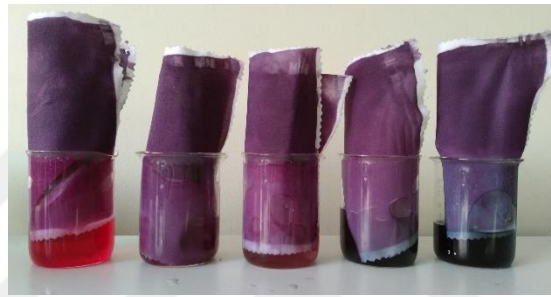
Görsel 53: Sentetik pat ile hazırlanmış boyanın, farklı pH değerlerinde gözlemlenen renk değişimleri (Yıldız, 2019)
