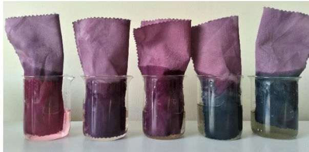
Görsel 49: Boyama sonrasında pH değerlerinde gözlemlenen renk değişimleri (Yıldız, 2019)
