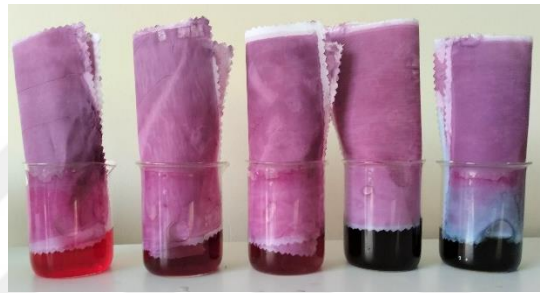
Görsel 55: Sentetik pat ile basılmış poliester kumaşların farklı pH değerlerindeki renk değişimleri (Yıldız, 2019)
