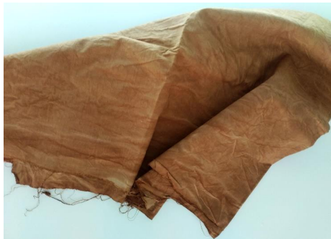
Görsel 75: pH 12 Değerindeki Bazik Ortamda Çektirme Yöntemi ile Boyama (Yıldız, 2019)
