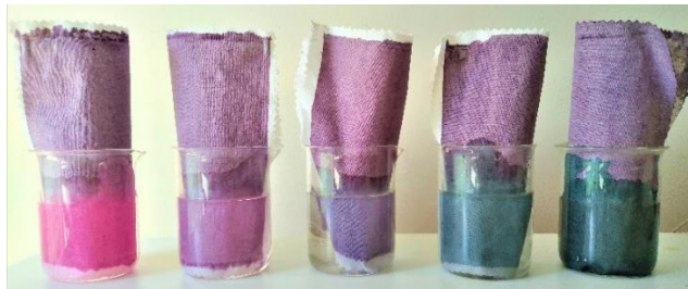
Görsel 59: Alginat pat ile basılmış poliamid kumaşların farklı pH değerlerindeki renk değişimleri (Yıldız, 2019)
