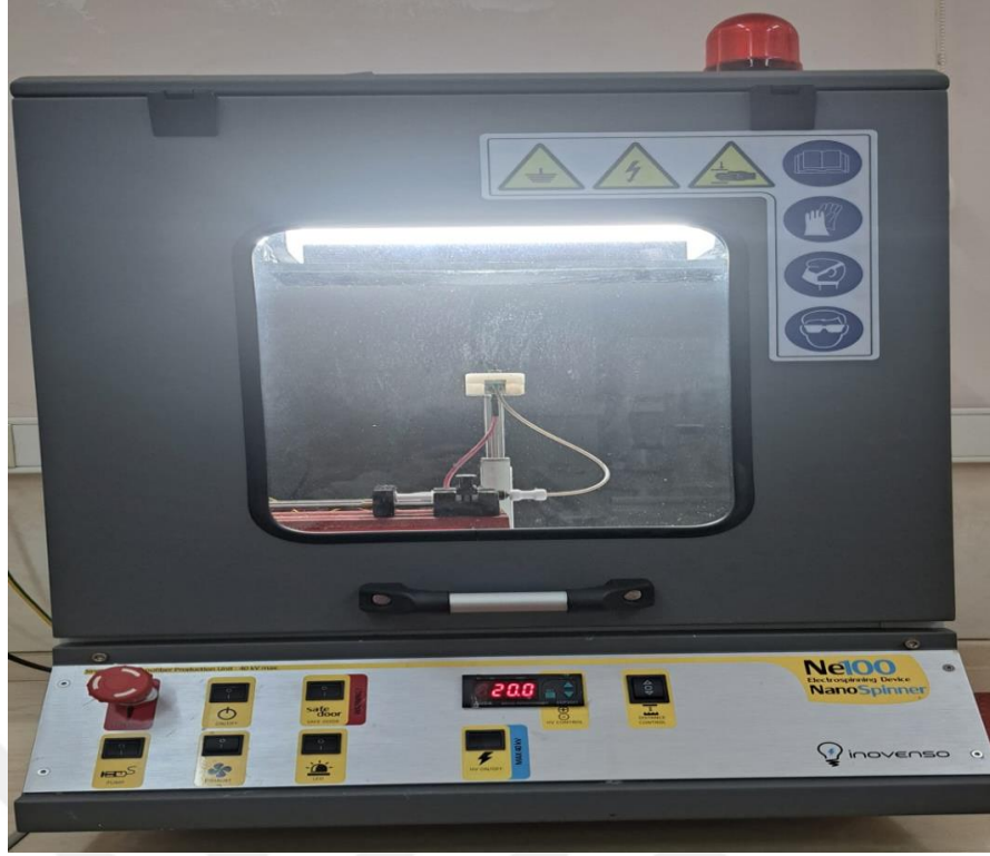
Şekil 3.2. Çalışmalarda kullanılan elektroğirme cihazının görseli
