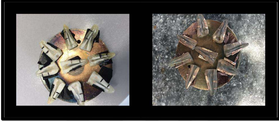
Resim 13. Örneklerin tabla üzerine yerleştirilip altın-palladyum kaplanması
