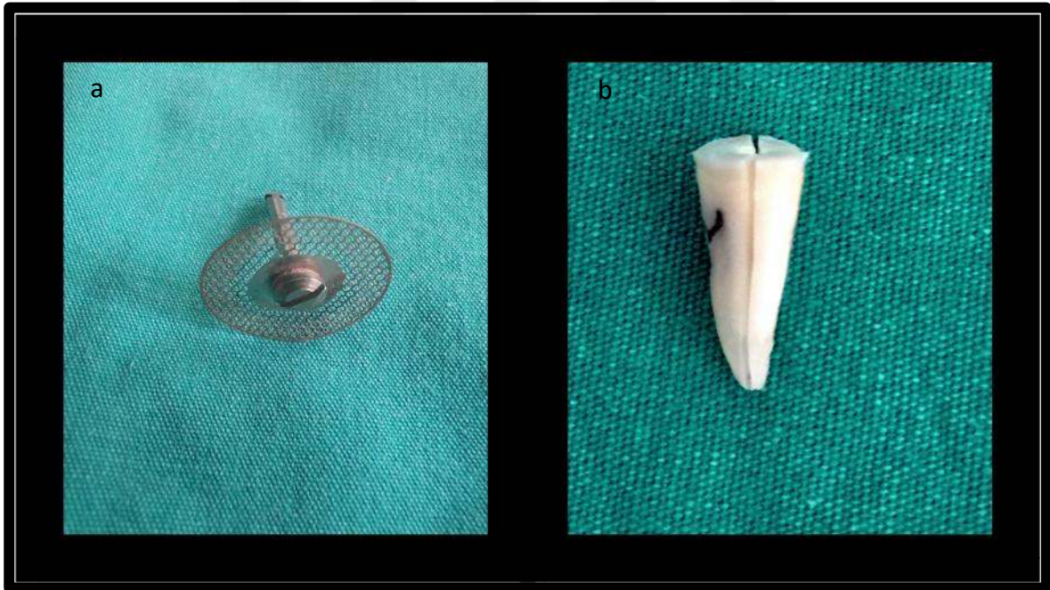
Resim 8. Örneklerin oluk açılması (a) Stripping diski (b) Dikey yönde oluk açılmış örnek
