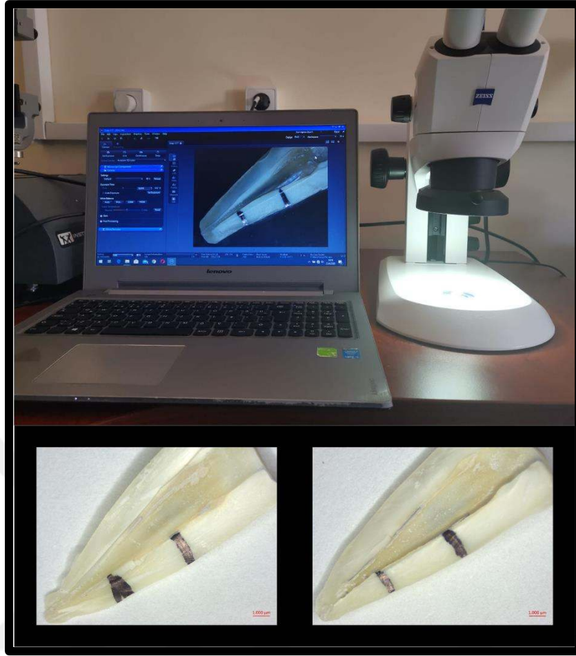
Resim 11. Örneklerden Zeiss Axiocam 105 color stereo mikroskobu ile x8 büyütme altında alınan görüntü
