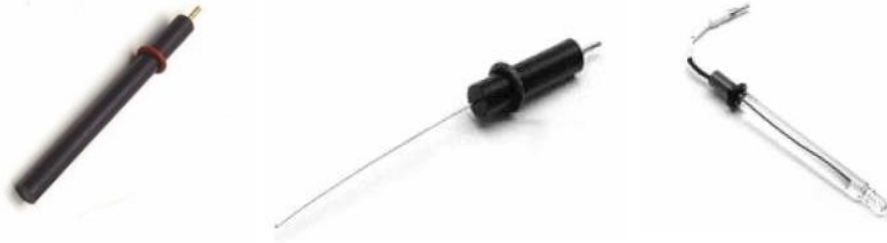
Şekil 3.3. Camlı karbon elektrot, Platin tel ve Ag /AgCl (3 M NaCl) elektrot.
