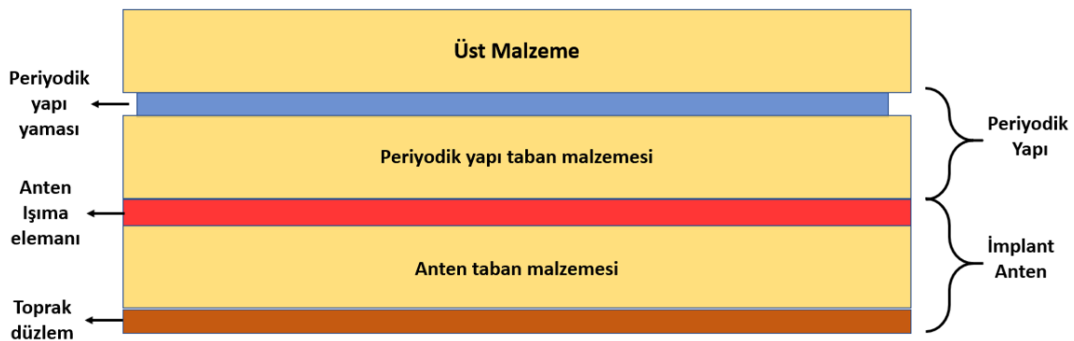
Şekil 3.42. Periyodik yapı ve anten konumu
