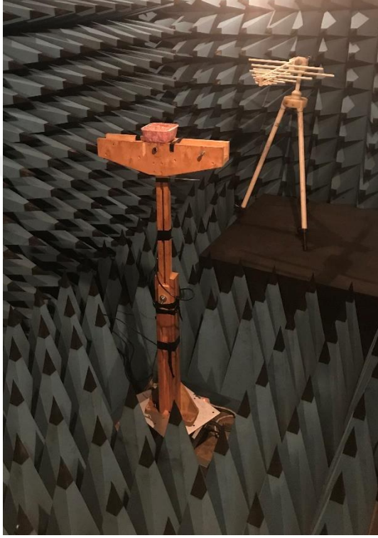
Şekil 4.16. PÇYD-İMA ve MÇK-İMA için ışıma örüntüsü ölçüm düzeneği
