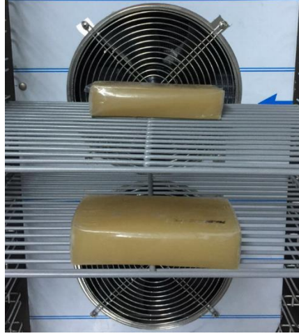
Şekil 3.5: Deneye alınan Blast Freezer içerisine paketlerin yerleştirilmesi
