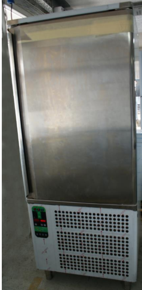
Şekil 3.4 : Deneye alınan Blast Freezer'in görüntüsü
