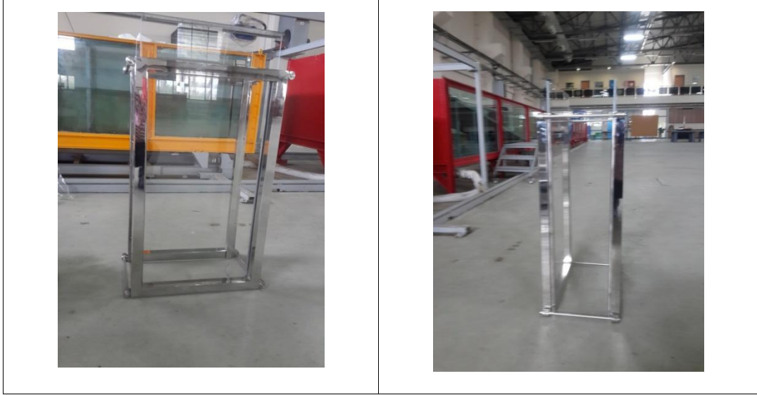
Şekil 3.18 Beton blok modellerin yerleştirildiği yan yüzeyi pleksiglass genişliği ayarlanabilir kılıf
