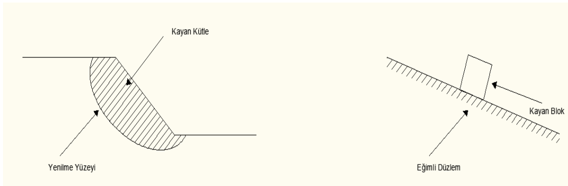
Şekil 2.26 Potansiyel heyelan ve eğimli düzlem üzerindeki blok
