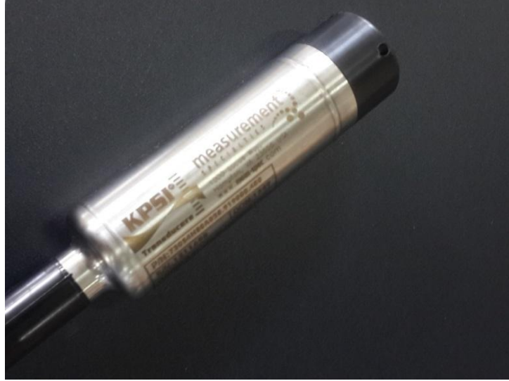
Şekil 3.10 Deney sisteminde kullanılan boşluk suyu basıncı ölçen sensör
