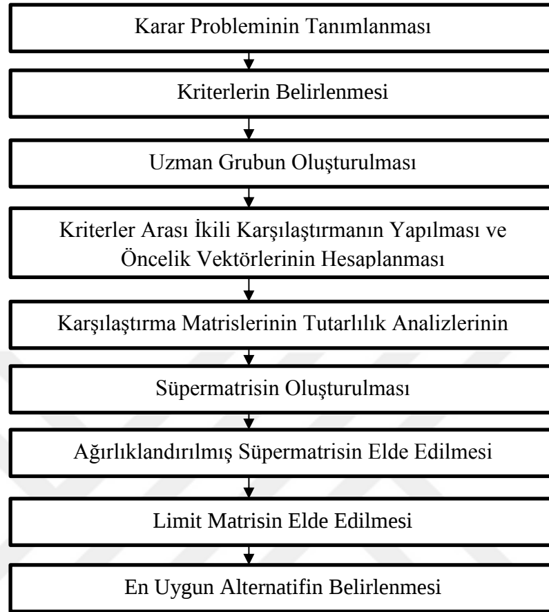
Şekil 8. AAS Akış Diyagramı
