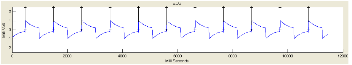
Şekil 4.21 Ortamda telsiz telefon çalışması sonucu oluşan sinyal.
