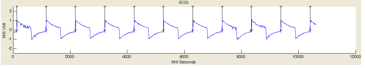
Şekil 4.20 Ortamda mikrodalga fırın çalışması sonucu oluşan sinyal.
