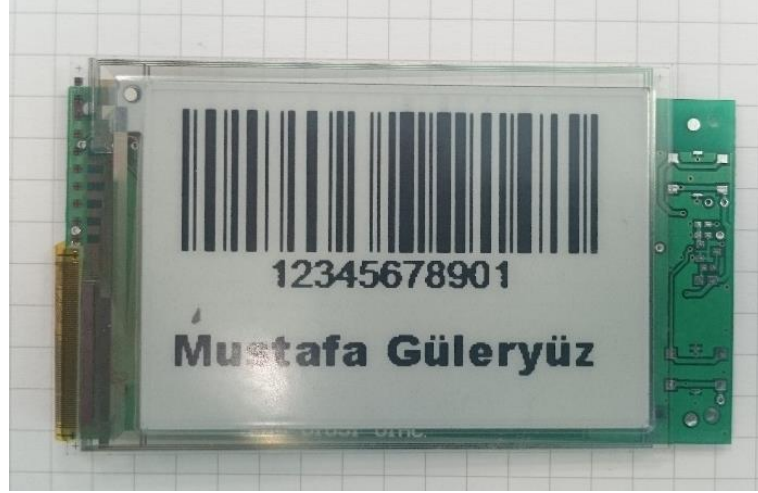
Şekil 4.6 : E-ink hareketli düğüm donanımı ön yüz.
