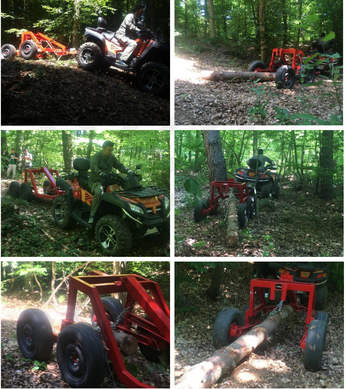
Şekil 4.6: Lastik tekerlekli ATV kullanılarak rnn bir ucunun askıda taşınmasına imkn veren rmork ile srtme işlemi.
