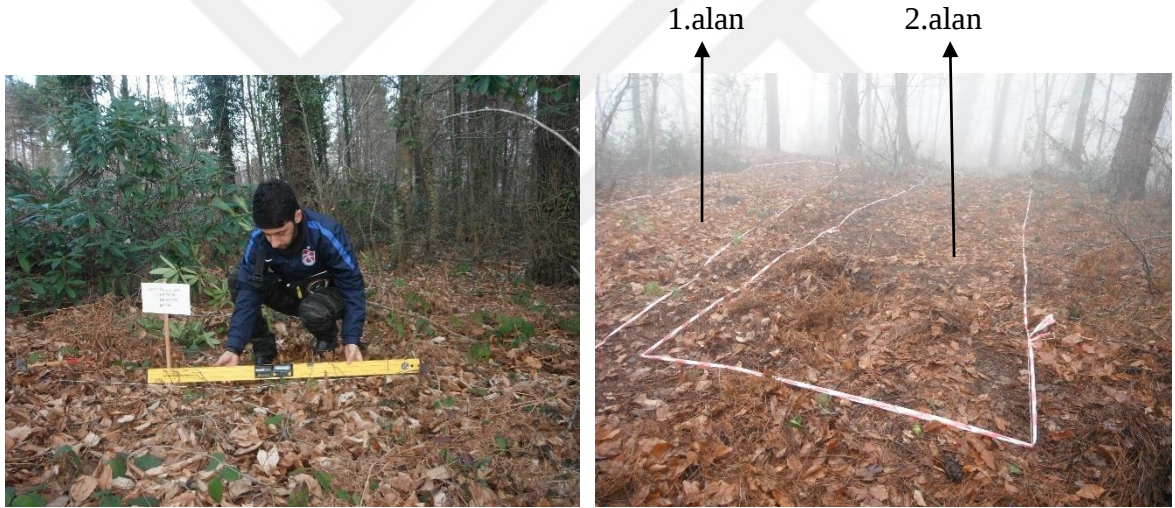
Şekil 3.13: Birbirine paralel sürütme şeritlerinin oluşturulması.
