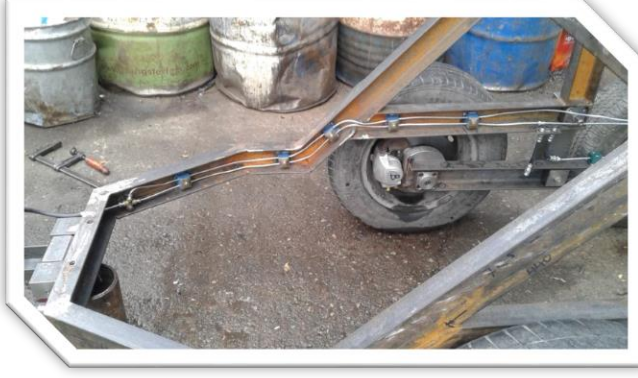
Şekil 13: Fren sistemi (ana fren merkezi hem ön hem de arka tekerlere baskı yapacak şekilde 2 kademeli olarak yapılmıştır)
