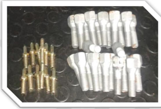
Şekil 5: Jant merkezi ve bijon cıvataları ile kamalar
