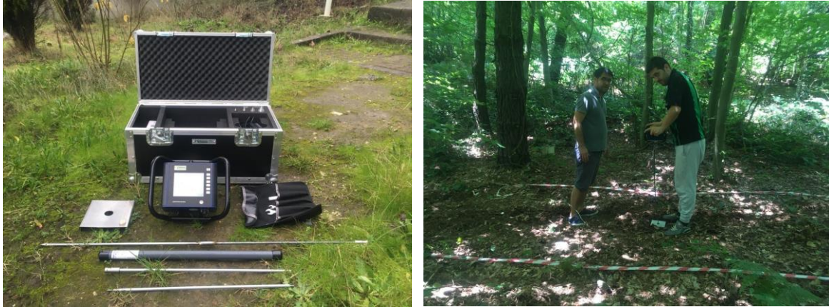
Şekil 3.37: Penetrologger toprak sertlik ve sıkışıklık ölçer cihazı.
