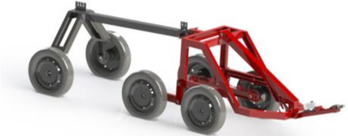
Şekil 3.7: Ürünün iki ucunun askıda taşınmasına imkân veren römork (tasarlanan 2. ekipman).
