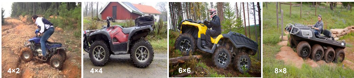
Şekil 1.2: Farklı çekiş tipine (hareket sistemi) sahip ATV'ler (Anon., 2018).
