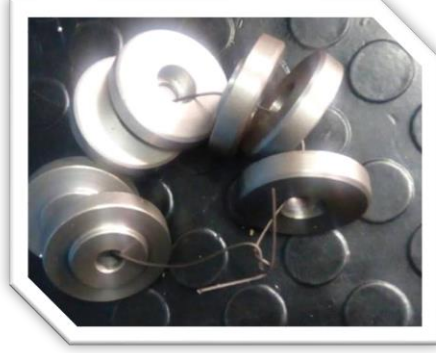
Şekil 4: Ana fren merkezi ve tandem fren sisteminin karşı yatak merkezlemesi
