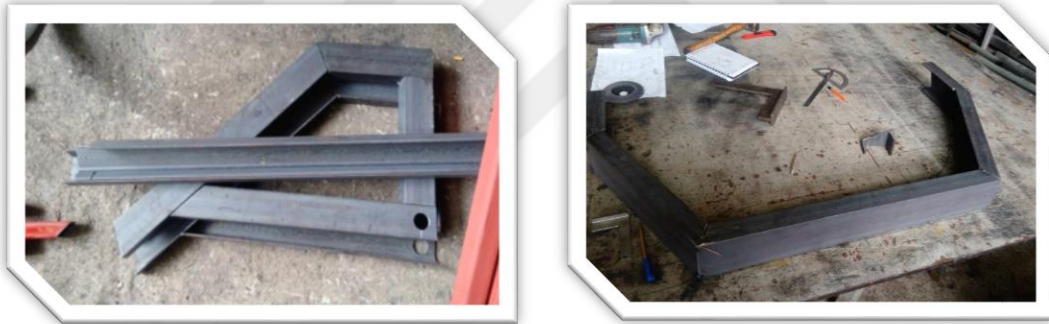
Şekil 2: Şasenin yukarı kaynaklı olan parçaları
