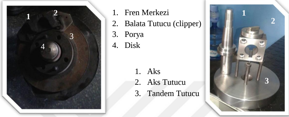
Şekil 1: Tofaş marka binek otomobile ait fren sistemi ve poryanın bağlandığı aks
