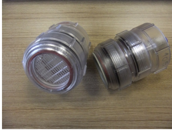
Şekil 3.5. SFU başlığının içine konulan filtre kaseti
