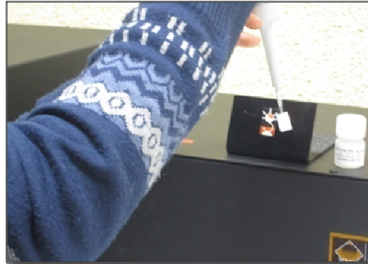
Şekil 3.13. Boş filtre üzerine sükroz ilavesi
