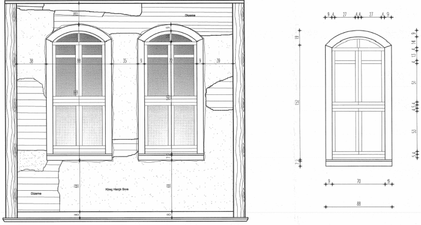
Çizim 3: Pencere A-A çizimleri (Ankara Kültür ve Tabiat Varlıklarını Koruma Bölge Kurulu arşivinden alınmıştır.)
