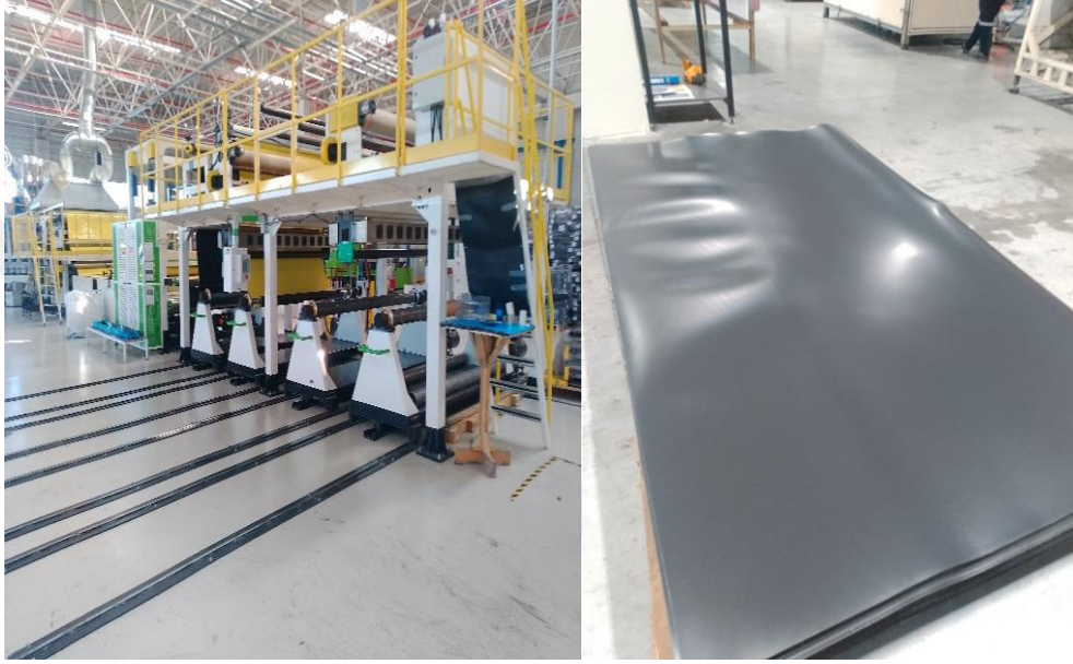
Şekil 2.5. Geomebran makinesi ve makinede üretilen ürün
