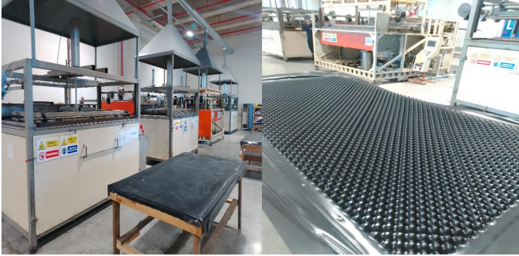
Şekil 2.8. Vakum makinesi ve makinede üretilen ürün
