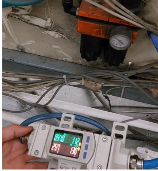
Şekil 3.3. Membran makinesi hava kaçak ölçümü
