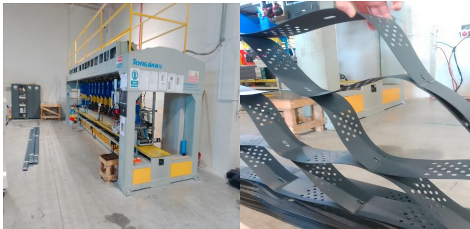
Şekil 2.7. Geocell makinesi ve makinede üretilen ürün
