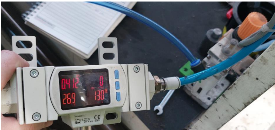
Şekil 3.10. Drenaj makinesinde 4,12 bar'da hava tüketim ölçümü
