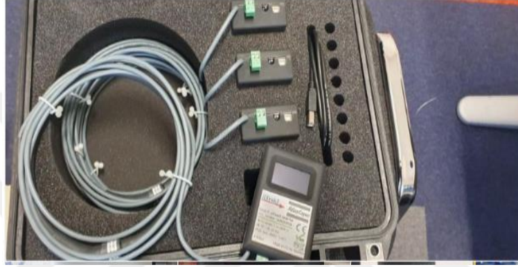
Şekil 2.2. Kompresör ölçümünde kullanılan Atlas Copco ölçüm cihazı (Atlas Copco, 2024)
