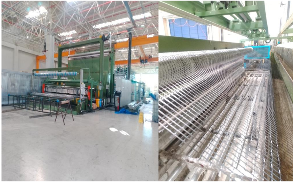
Şekil 2.4. Geogrid makinesi ve makinede üretilen ürün
