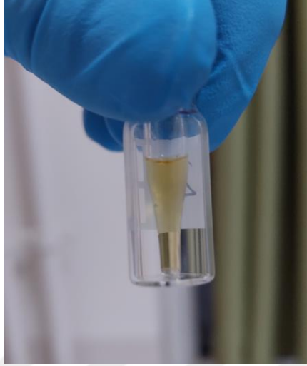
Fotoğraf 3.7. Viallere aktarılarak GC-MS analizine hazır hâline getirilen örnek
