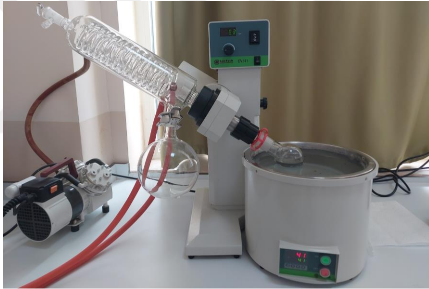
Fotoğraf 3.4. Cam balona alınan örneklerin evaporatörde konsantre edilmesi işlemi
