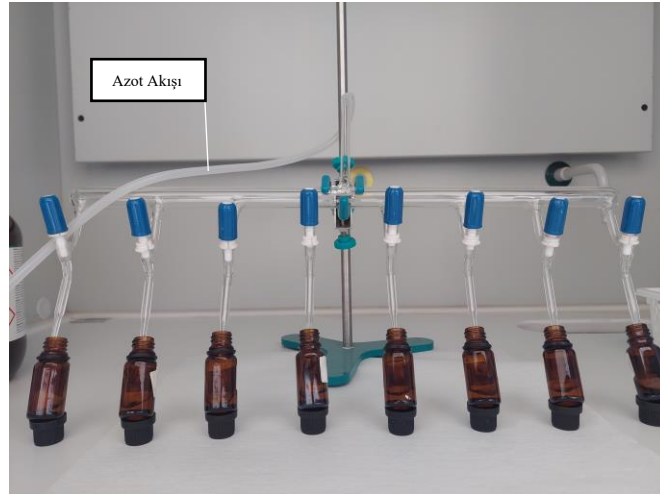
Fotoğraf 3.6. Örneklerin azot gazı altında uçurulması işlemi
