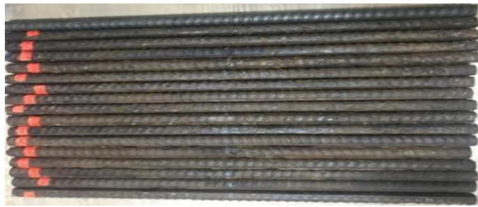
Şekil 5.6. Çekme deneyi uygulanan betonarme kupon donatıları.
