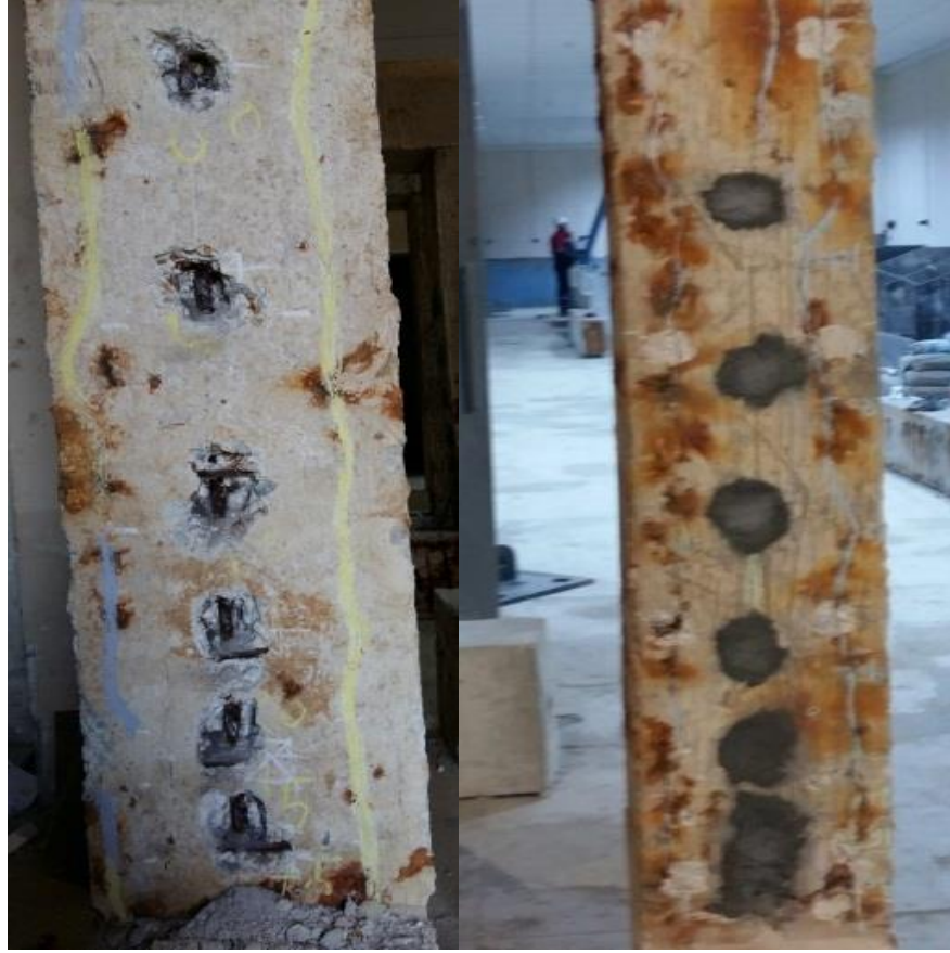
Şekil 4.45. Gerinim ölçerlerin yapıştırıldığı kısımlara tamir harcının uygulanması.
