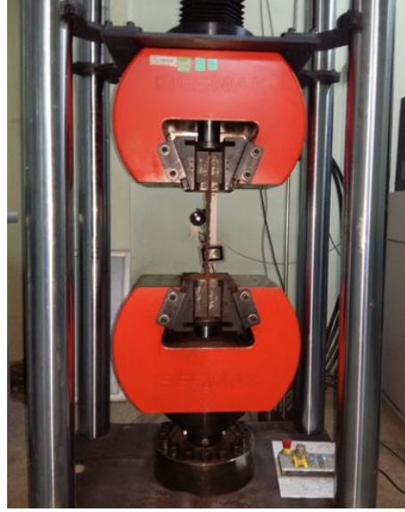
Şekil 4.2. Betonarme donatılarına uygulanan donatı çekme deneyi.
