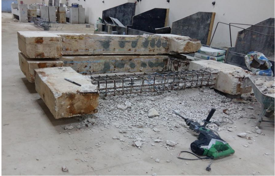
Şekil 5.1. Betonarme kolonların yükleme deneylerinden sonra kırılması işleri.
