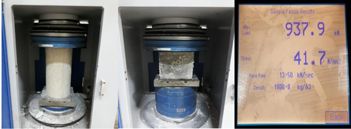
Şekil 4.1. Silindir ve küp numunelerin beton basınç deneyleri.
