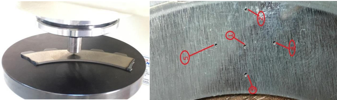
Şekil 5.8. Numunelerin sertlik ölçüm yapılışı
