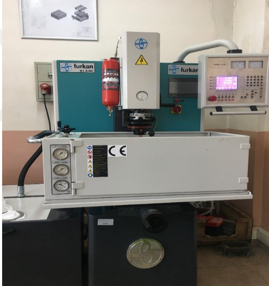
Şekil 5.1. Deneylerde kullanılan EEİ tezgâhı
