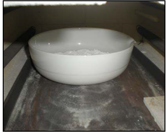
Şekil 2.3. MCM-41'in kalsinasyon öncesi fırın içerisindeki görüntüsü
