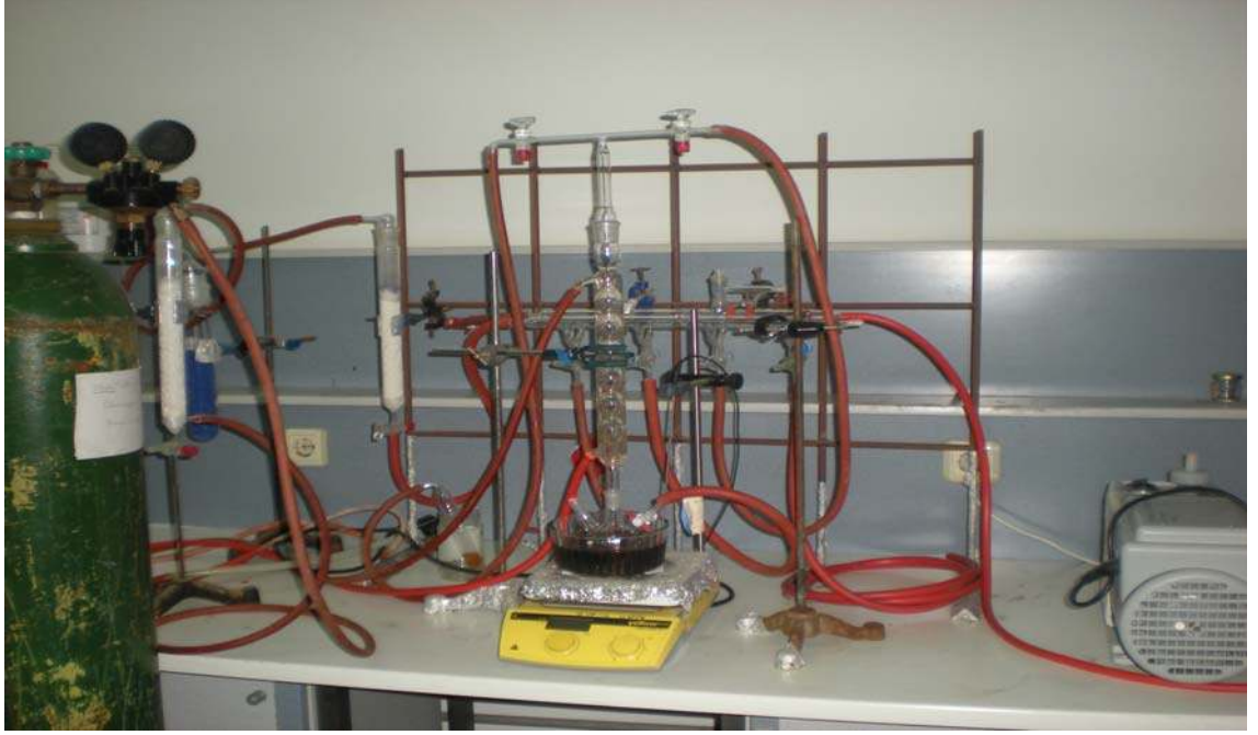
Şekil 2.4. Heterojen katalizör varlığında MPV indirgenme reaksiyonu düzeneği
