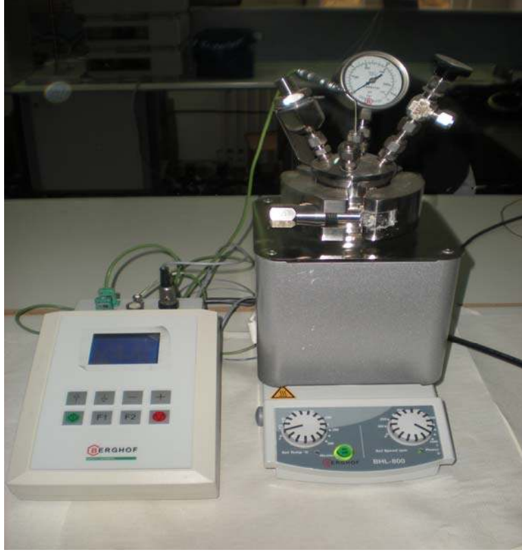
Şekil 2.2. MCM-41'in hazırlanması için kullanılan BERGHOF BR-200 reaktör.
