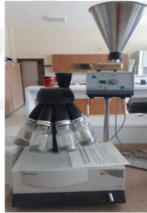
Şekil 3.20 Kavanozlu numune bölücü görseli.
