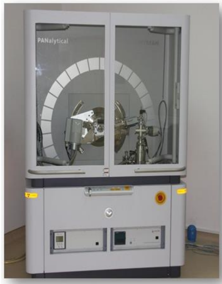
Şekil 3.3. XRD Cihazı (Panalytical marka Empyrean model)
