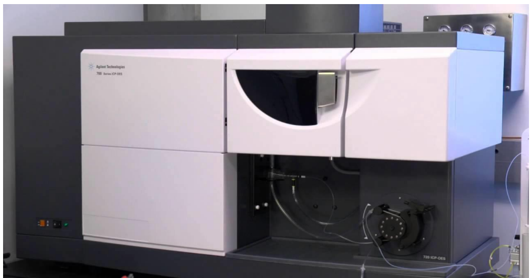
Şekil 3.1. İndüktif eşleşmiş plazma-kütle spektrometresi (ICP-MS)
