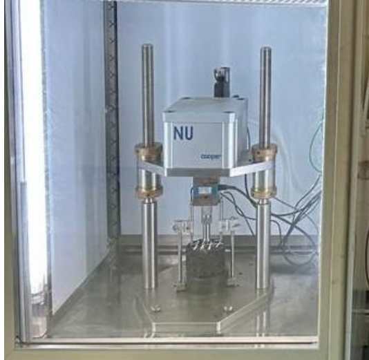
Şekil 35. Dinamik sünme deneyi uygulanan numune
