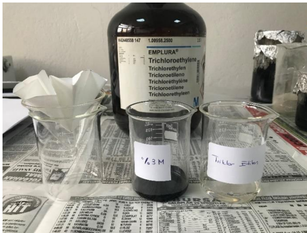
Şekil 69. BA3.0 modifiyeli asfalt bağlayıcının trikloretilende çözünmesi
