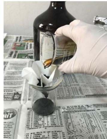
Şekil 69. BA3.0 modifiyeli asfalt bağlayıcının trikloretilende çözünmesi
