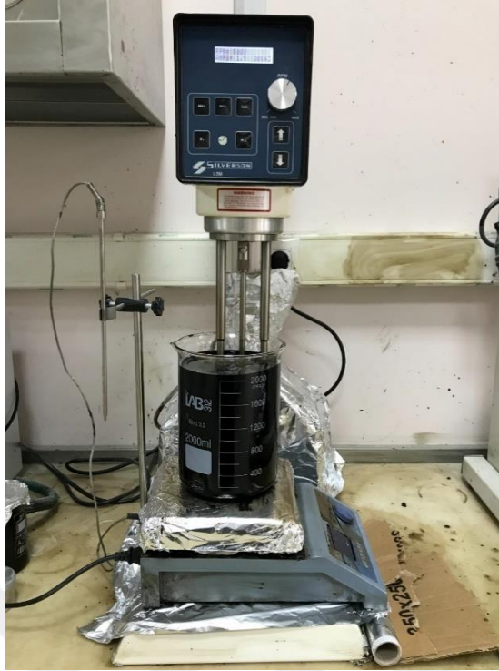
Şekil 44. Modifiye asfalt bağlayıcıların üretilmesi (Yüksek Parçalayıcı Karıştırıcı)
