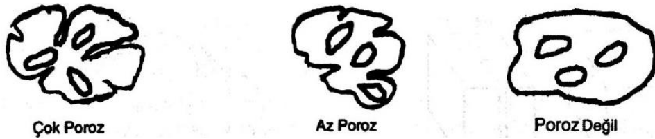
Şekil 30. Porozite sınıflandırması (Tunç, 2007)
