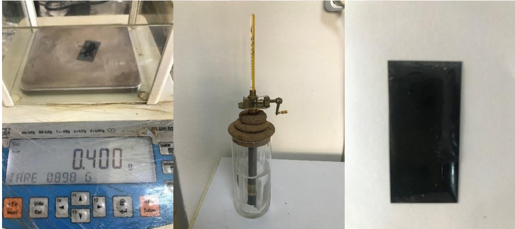
Şekil 9. Fraass kırılma noktası cihazı ve deney sonrası kırılan numune
