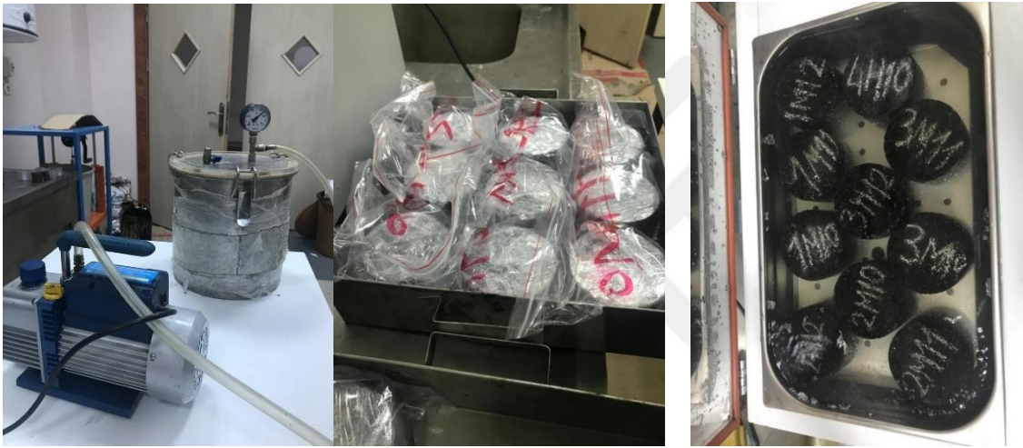
Şekil 54. Su hasarına maruz bırakılan numunelerin koşullandırma aşamaları
