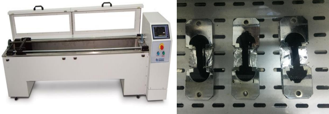
Şekil 7. Düktilite cihazı ve deney için hazırlanan numuneler
