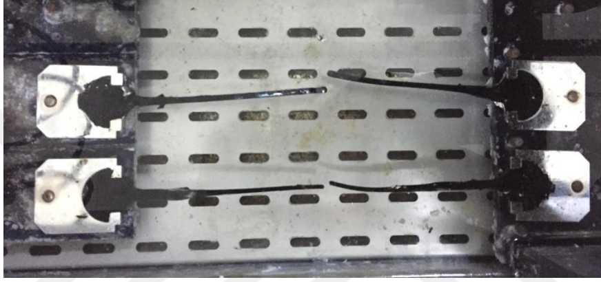
Şekil 8. Elastik geri dönme deneyinde kesilen bağlayıcı numuneleri
