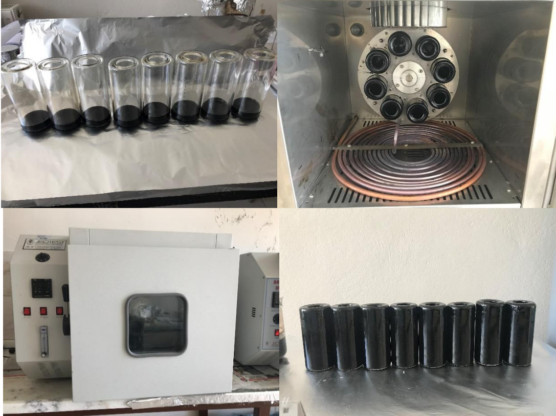
Şekil 10. Dönel ince film halinde ısıtma deneyi ve aşamaları
