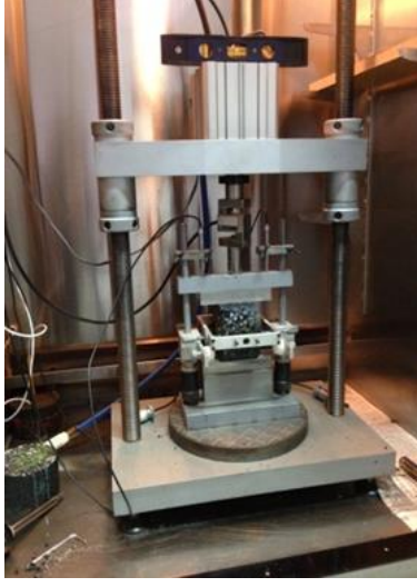
Şekil 37. Dolaylı çekme yorulma deneyi uygulanan numune
