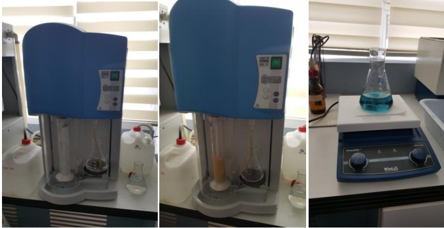
Şekil 3.1. Kjeldahl yöntemi ile toplam azot tayini
